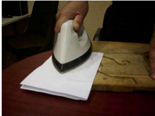
FIGURA 32. Planchado del acetato en la placa de cobre.
