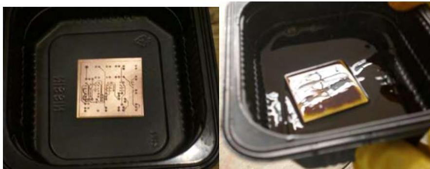
FIGURA 33. Desprendimiento del cobre por acción del cloruro férrico, y placa
