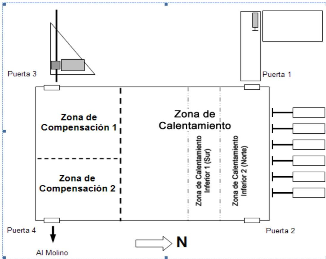
Figura 3. 8. Zonas del horno de recalentamiento.
