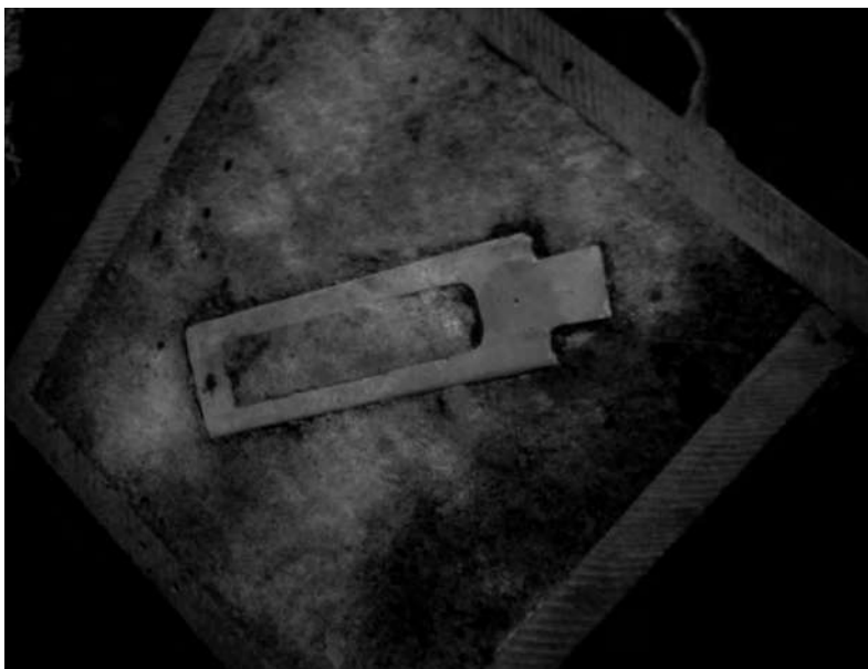
Fig. 5.2 Modelo incrustado en arena.
