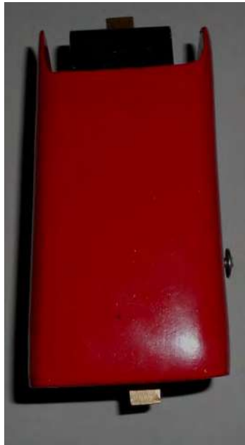
Fig. 5.14 Cubierta de fibra de vidrio y pintado de la pieza lo cual proporciona una mejor apariencia.
