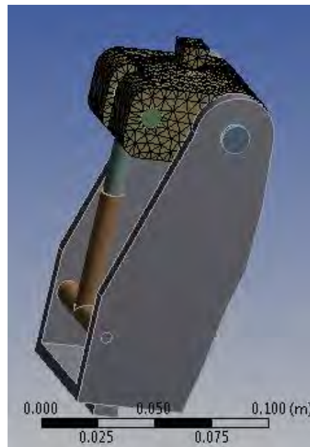
Fig. 4.12 Mallado del Eslabón 1
