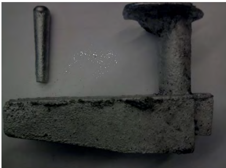
Fig. 5.4 Desmoldeo y desbarbado.
