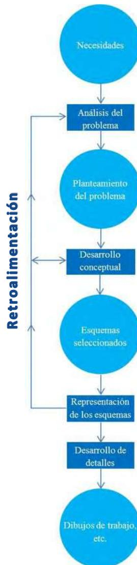
Figura 1. 2. Modelo de French de proceso de diseño.
