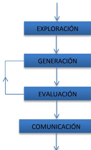
Figura 1. 1. Un modelo sencillo de cuatro etapas del proceso de diseño.
