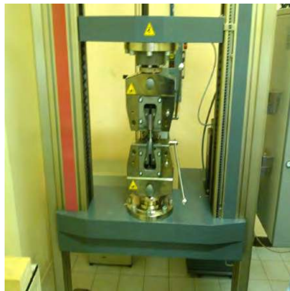
Figura3. 32.- Máquina de ensayo de tensión Zw/ck Roell Z100.
