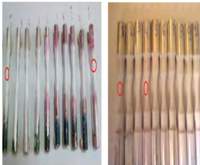
Figura3. 30.- Aplicación del ensayo de líquidos penetrantes a las probetas finales.
