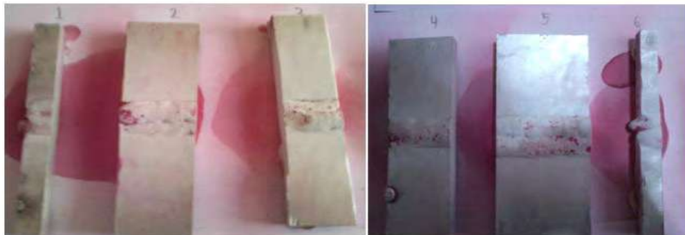
Figura3. 29.- Inspección de las placas soldadas.
