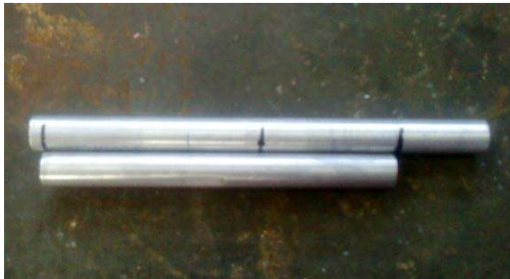
Figura3. 23.- Corte de las probetas cilíndricas a las dimensiones especificadas.
