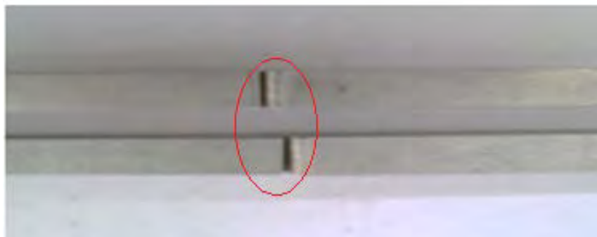
Figura3. 15.- Penetración nula del material de aporte en la raíz
