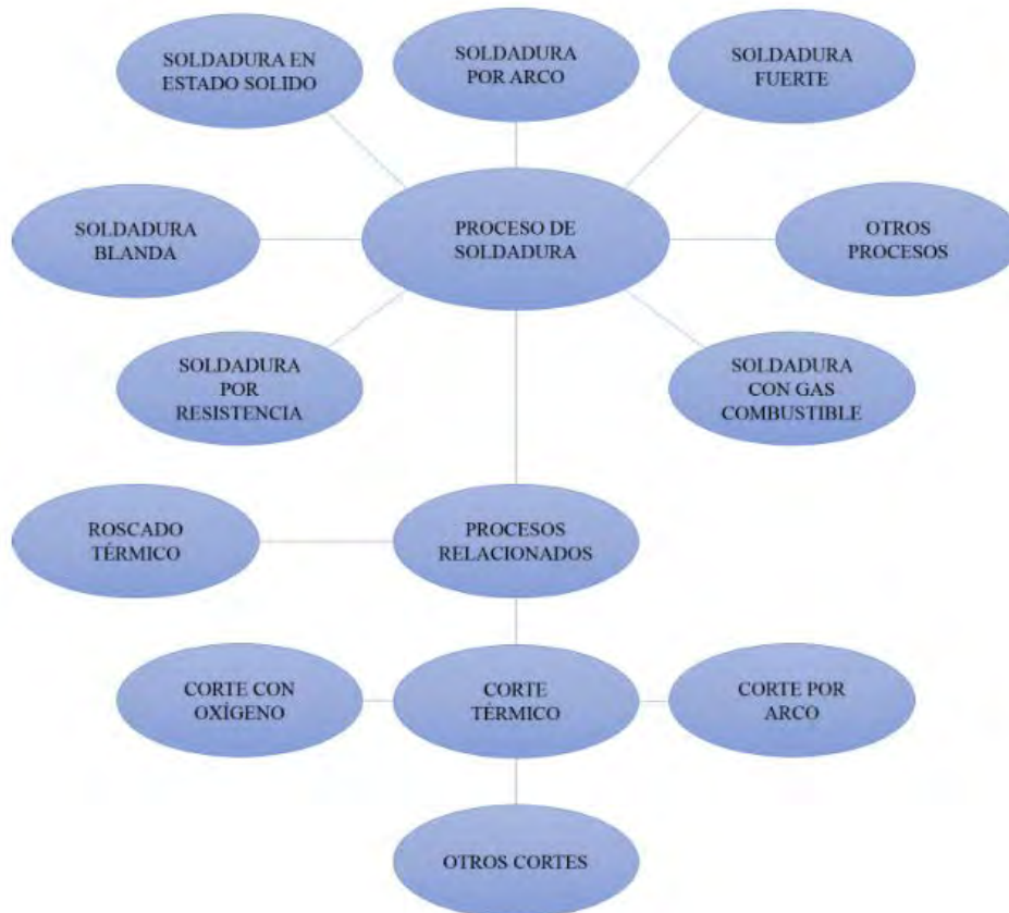
Figura1. 13.- Carta maestra de los procesos de soldadura (AWS).
