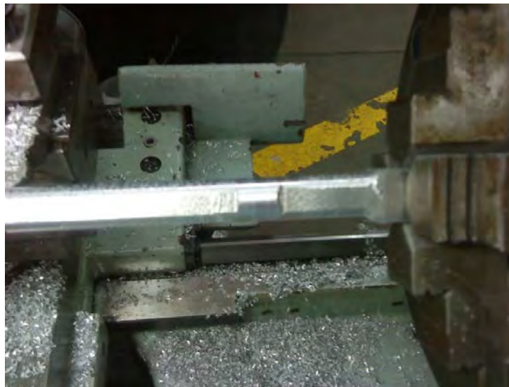
Figura3. 21.- Primer maquinado a la probeta en el torno de cuatro mordazas.
