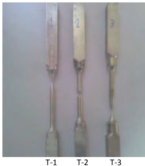
Figura3. 35.- Probetas de tensión fracturadas.
