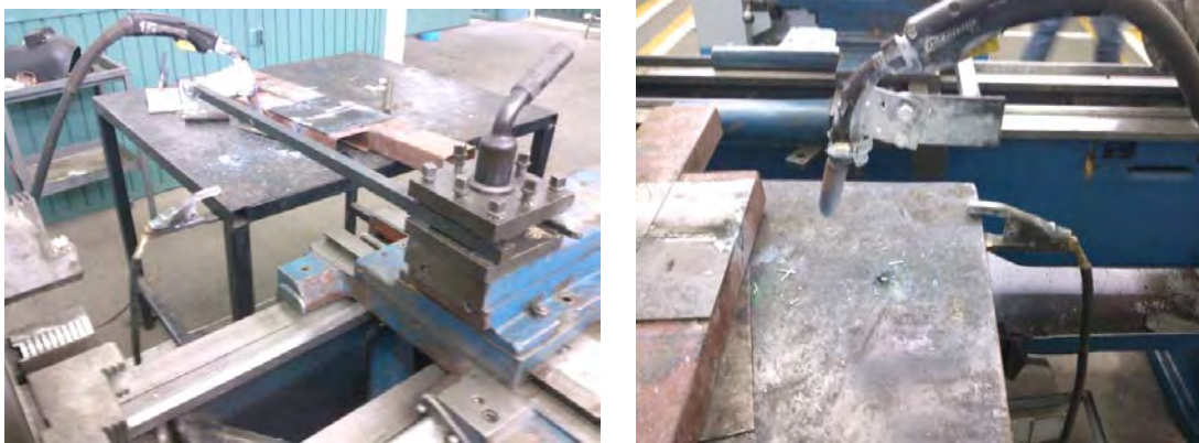
Figura3. 13.- Vista del montaje del brazo sujetador en el torno.
