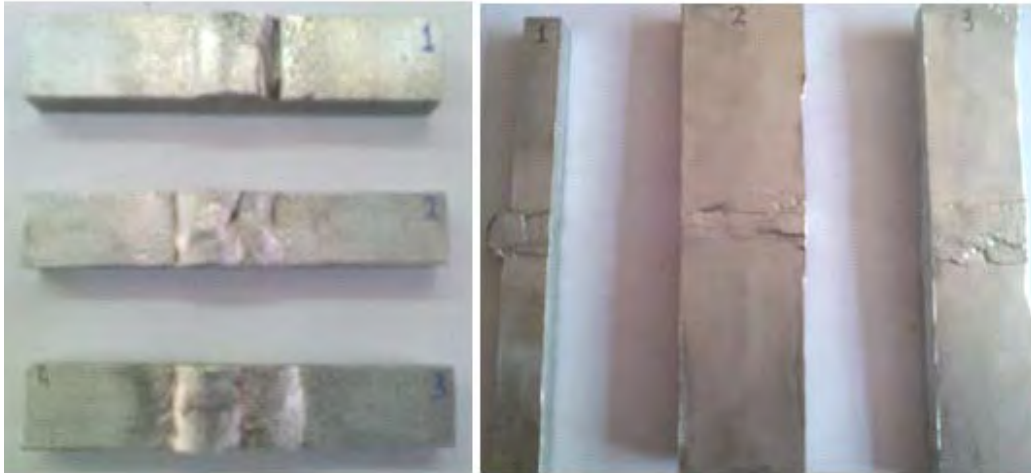
Figura3. 18.- Soldadura adecuada en las distintas placas.
