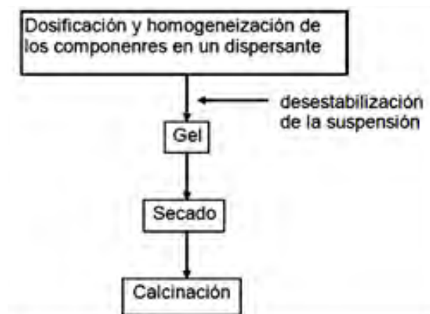
Figura 15. Diagrama de flujo de las principales fases de un procesado sol-gel [91].
