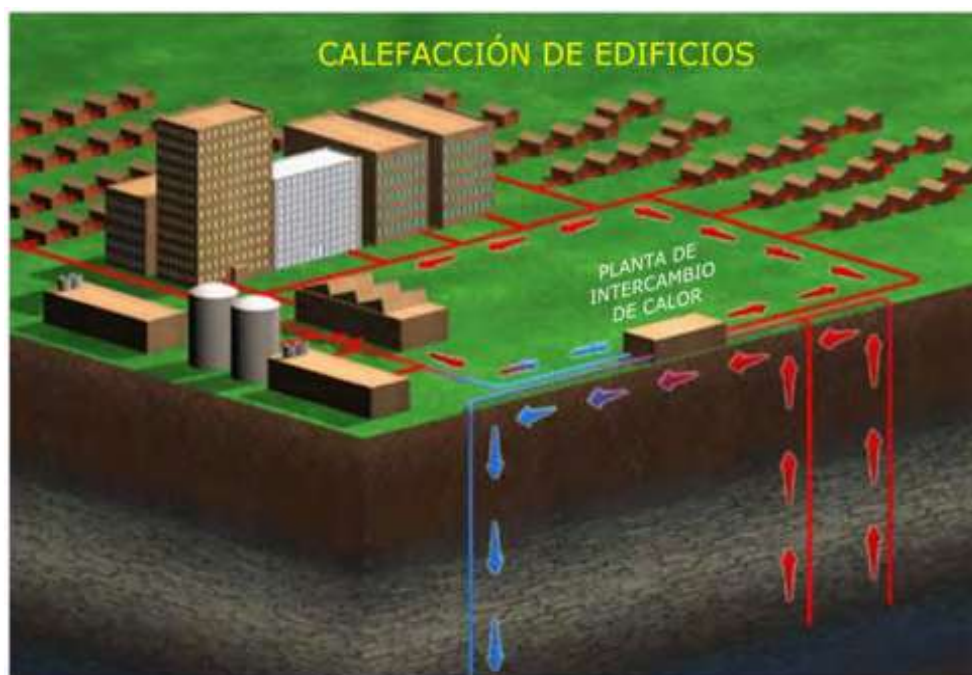
Figura 2.9: Esquema del suministro de ACS a edificios mediante energía geotérmica [15].
