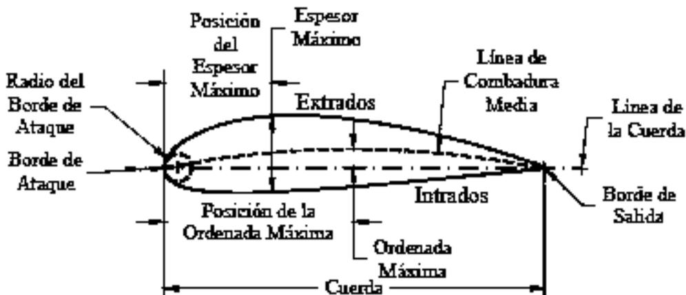
Figura 3.7 Esquema de un perfil aerodinámico con sus componentes.
