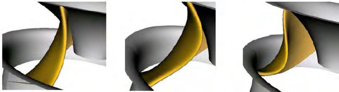
**Figura 1.4** Ejemplos de los álabes del rodete de una turbina Francis [13].
