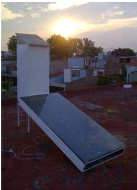
Figura 3.6: Deshidratador solar instrumentado y expuesto al medio ambiente.
