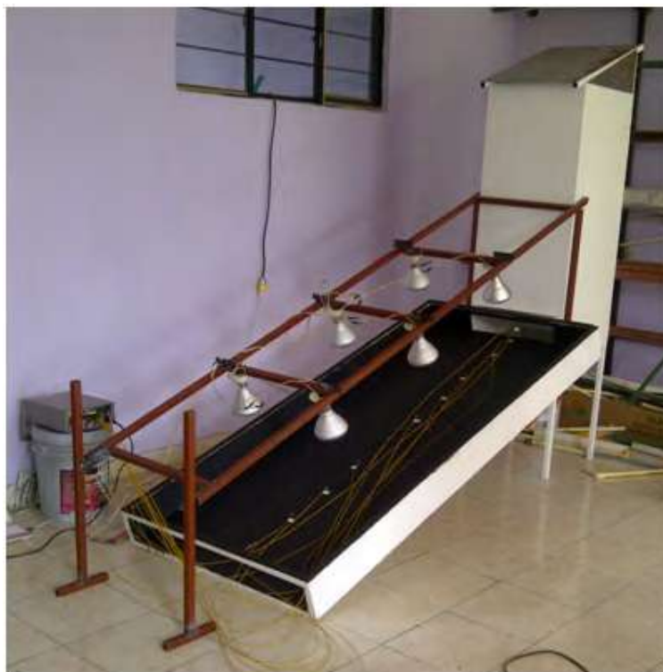
Figura 3.11: Montaje de laboratorio del deshidratador.
