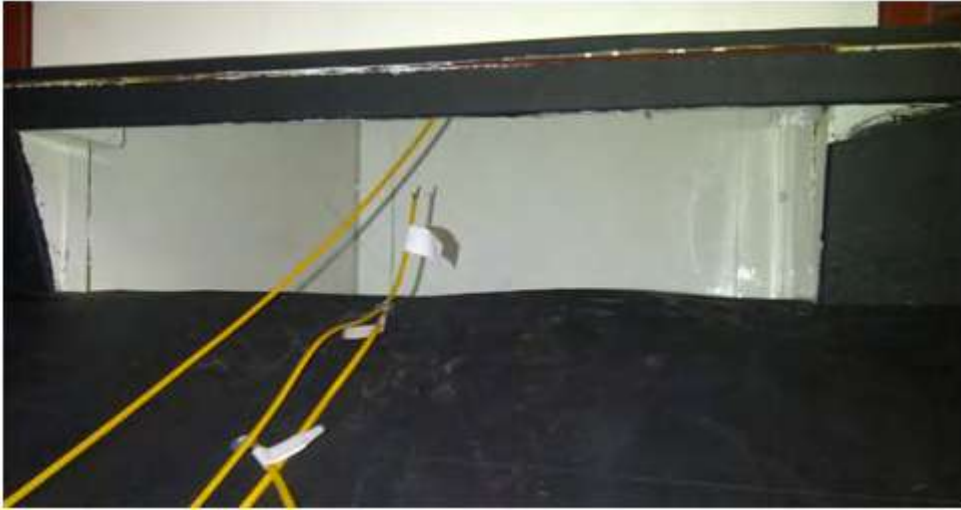
Figura 3.5: Termopar colocado a la entrada de la cámara de secado (salida del colector).
