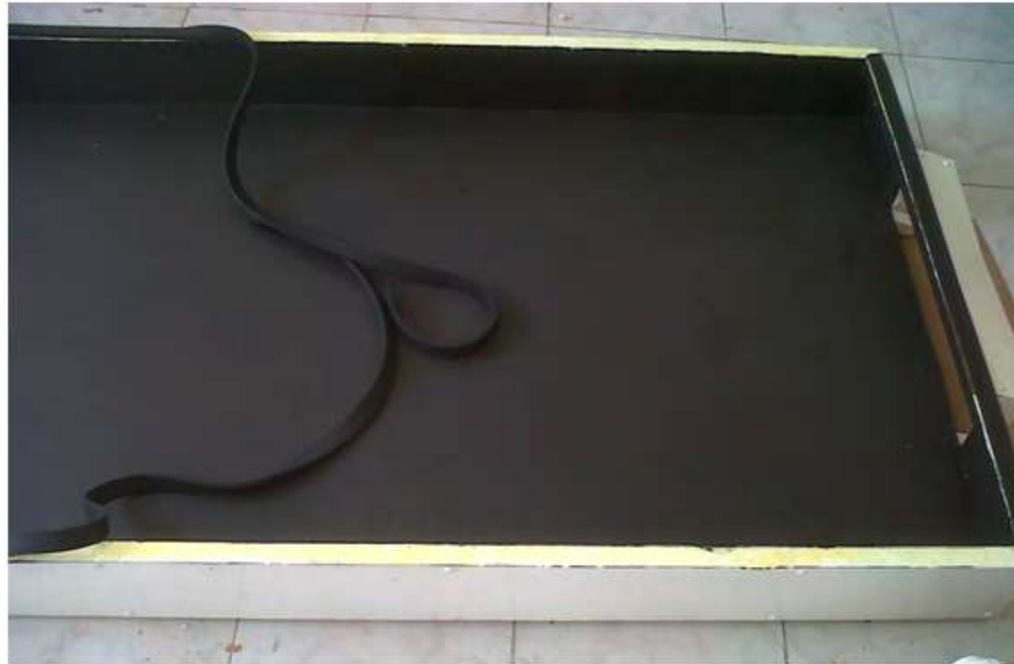
Figura A.7: Sello de hule utilizado para evitar el escape del aire caliente del colector.
