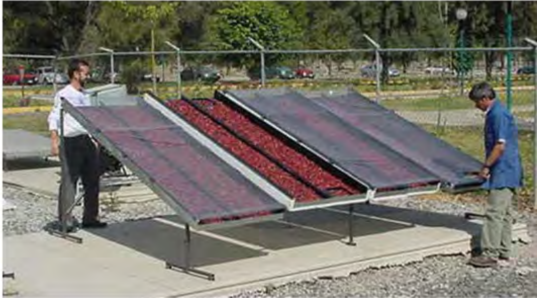
Figura 2.1: Secador solar de tipo directo [17].
