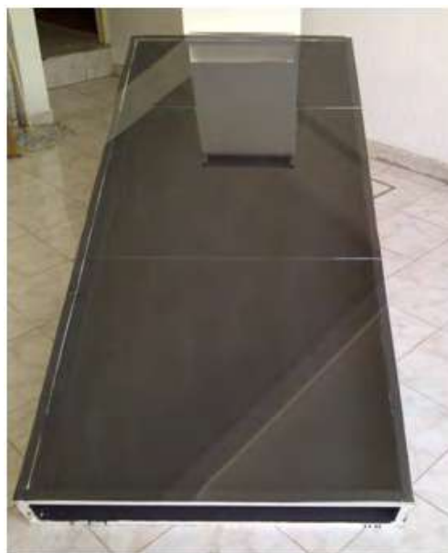
Figura A.8: Colector solar con la cubierta de vidrio.
