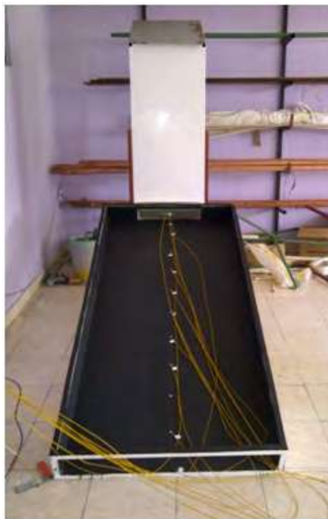
Figura 3.10: Deshidratador instrumentado para experimento en laboratorio.
