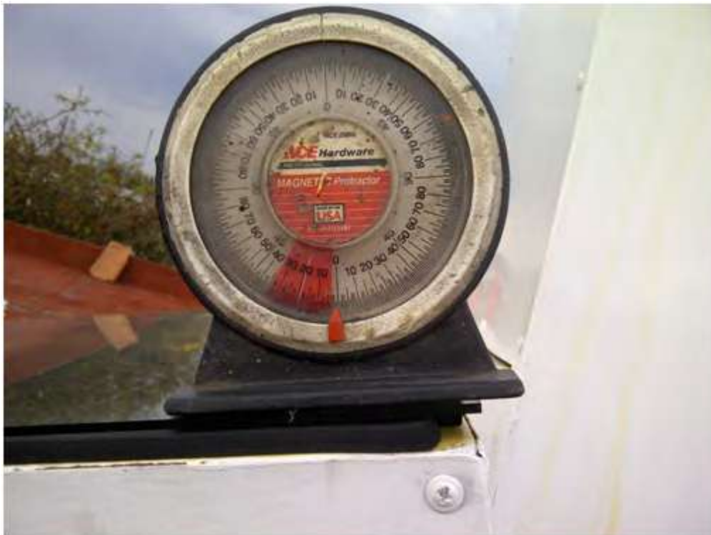
Figura A.4: Comprobación de la inclinación del colector a 20°.
