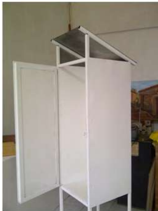
Figura A.5: Vista de la cubierta interior y exterior de lamina y puerta de la cámara de secado.
