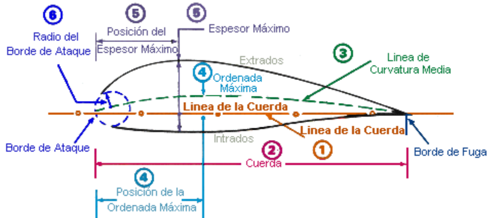
Figura 3.4. Terminología de los perfiles aerodinámicos [37].
