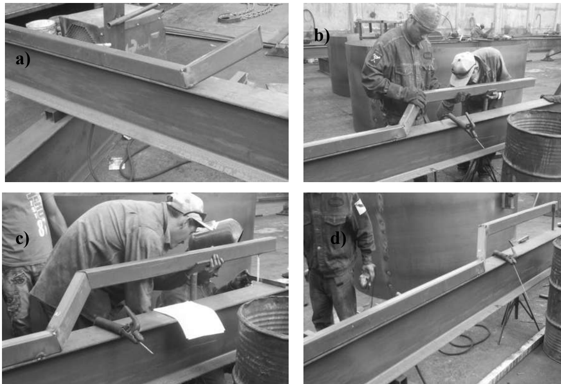
Figura 5. 11. Ensamble y nivelación del primer larguero.
