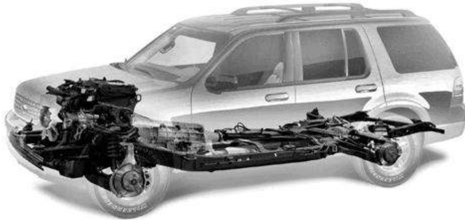
Figura 1. 13. Carrocería y chasis independiente [25].
