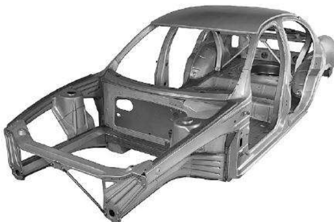
Figura 1. 19. Estructura integral moderna ultraligera [20].
