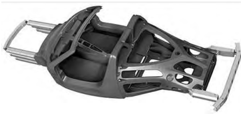
Figura 1. 14. Carrocería y chasis juntos (Monocasco) [26].
