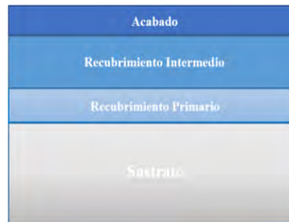
Figura 2.1. Sistema de pintura. [20]
