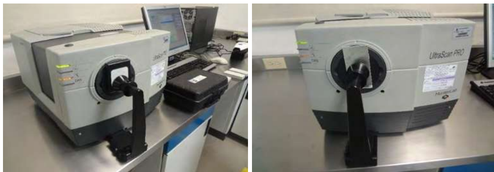
Figura 5.4. Espectrofotómetro de esferas integradas, calibración y medición de muestras.
