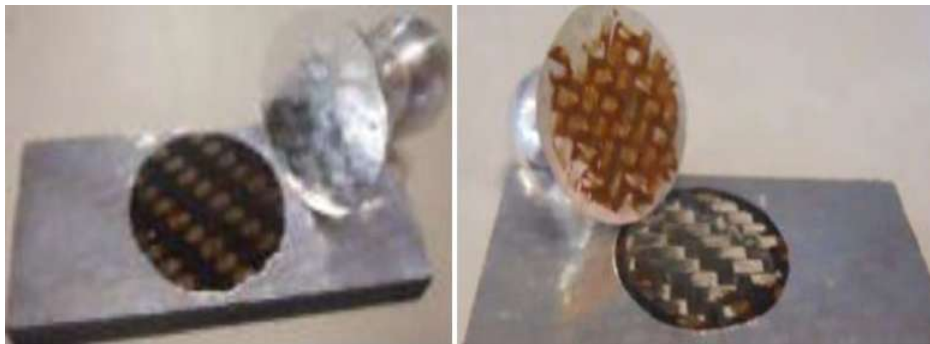
Figura 4.5. Ejemplos falla adhesiva y falla cohesiva. [75]
