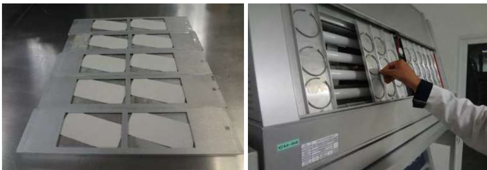
Figura 5.7. Posicionamiento y colocación de las muestras en la cámara de intemperismo.
