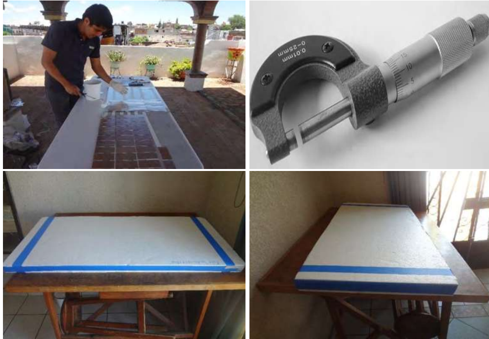
Figura 5.3. Pintado, medición del espesor, guardado y sellado de las probetas pintadas.
