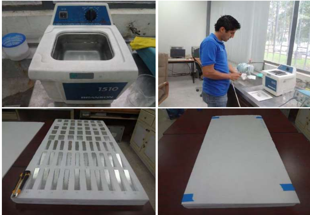
Figura 5.2. Preparación de la superficie y guardado de probetas.
