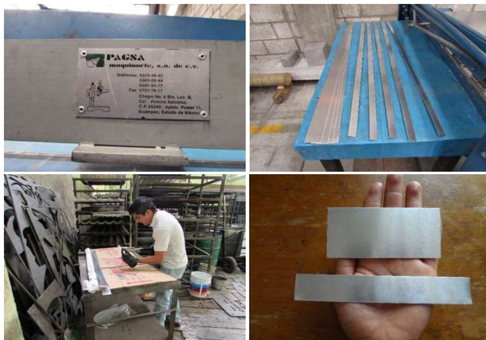
Figura 5.1. Proceso de cortado y obtención de probetas.
