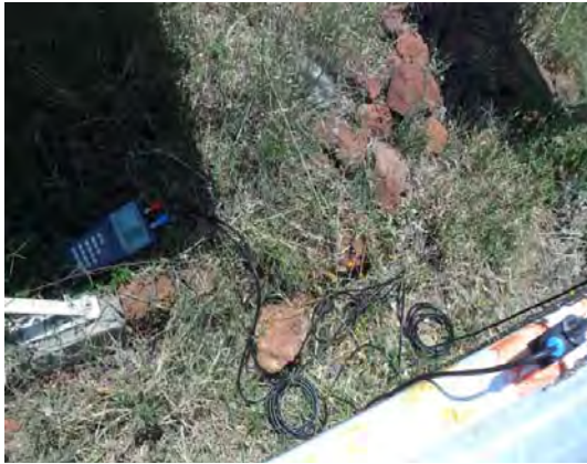
Figura 53. Conexiones del medidor de flujo en líneas de colectores parabólicos
