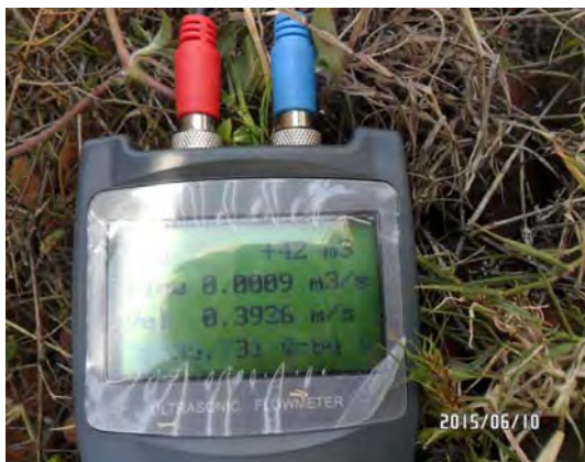
Figura 60. Flujo medio de prueba, 0.0009 \text{ m}^3/\text{s}
