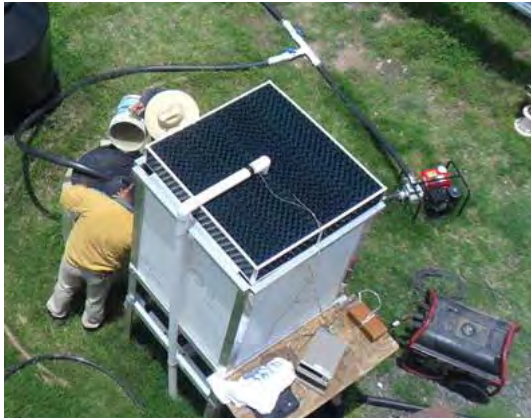
Figura 51. Conexiones comunes, bomba, tanque para agua y recirculación
