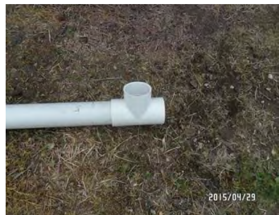
Figura 40. Conexión de T para derivación a la línea de colectores parabólicos
