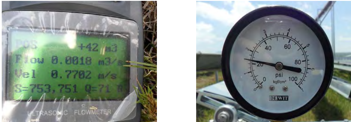
Figura 55. Flujo máximo en pruebas, 0.0018 \text{ m}^3/\text{s}
