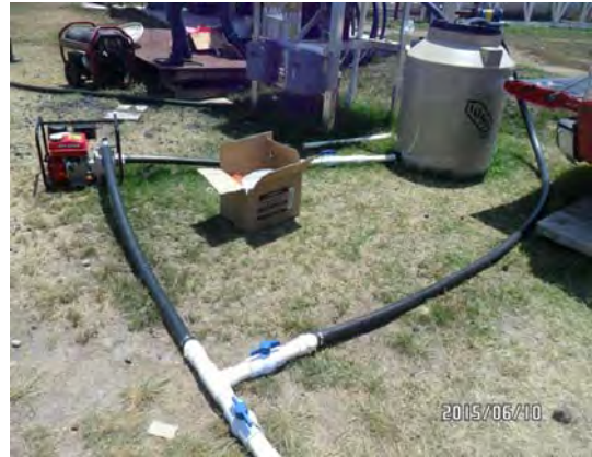
Figura 51. Conexiones comunes, bomba, tanque para agua y recirculación
