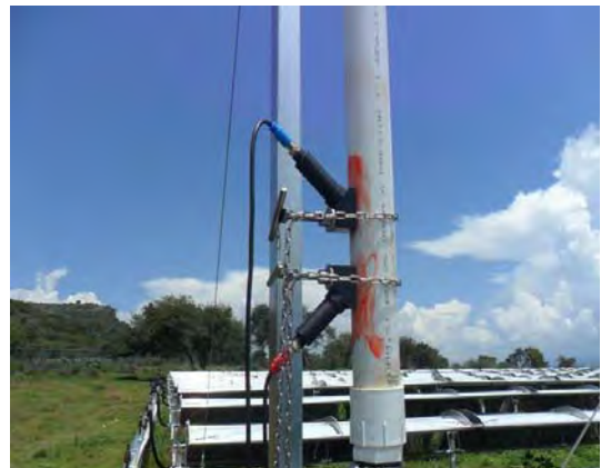
Figura 54. Conexiones del medidor de flujo en línea del colector fresnel
