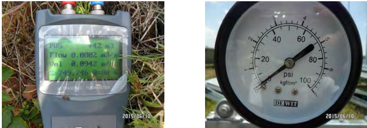
Figura 57. Flujo mínimo de pruebas, 0.0002 \text{ m}^3/\text{s}
