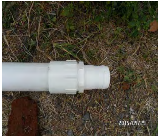
Figura 44. Conexión para manguera a la entrada y salida de los colectores parabólicos
