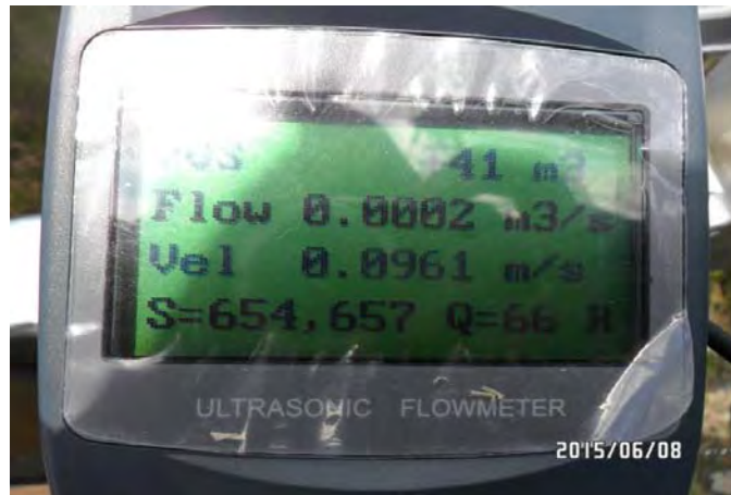
Figura 65. Flujo mínimo de prueba 0.0002 m 3 /s en colectores Fresnel
