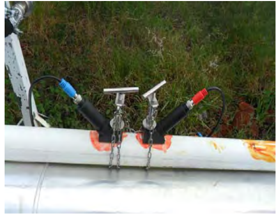
Figura 53. Conexiones del medidor de flujo en líneas de colectores parabólicos
