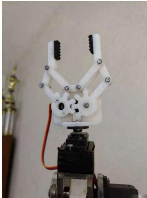
**Figura 40** Piezas de pinza robótica impresas en 3D
