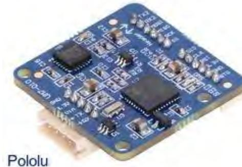
Figura 5 Sensor de orientación UM7-LT de la marca POLOLU
