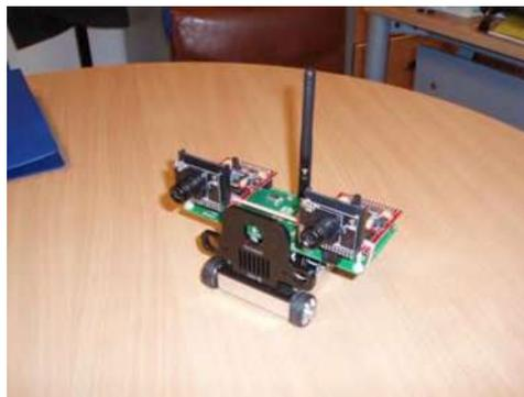
**Figura 6** Sensores de visión en configuración estéreo sobre un robot sencillo
