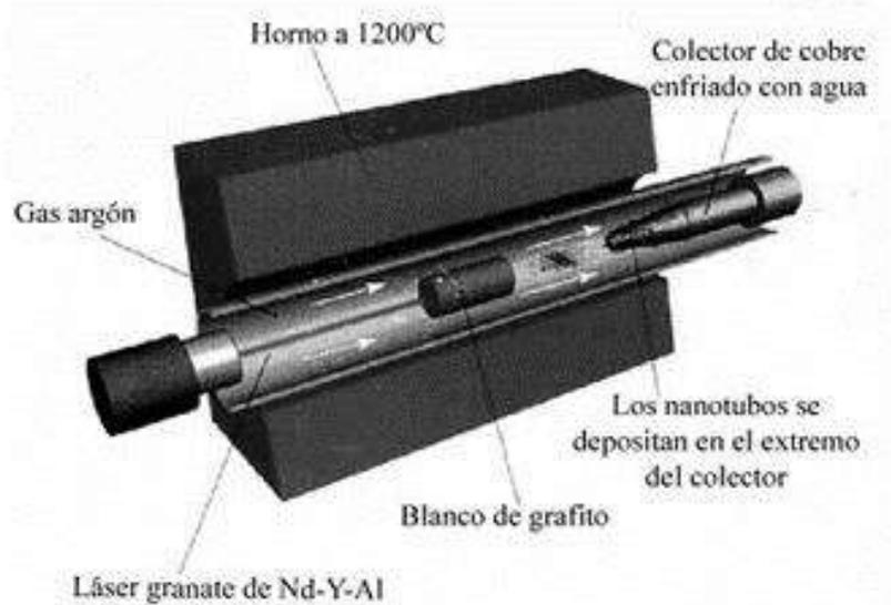
**Figura 9. Esquema del método de ablación láser.**
