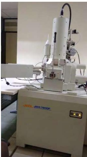
**Fig. 21. Microscopio electrónico de barrido de emisión de campo (IIM).**
