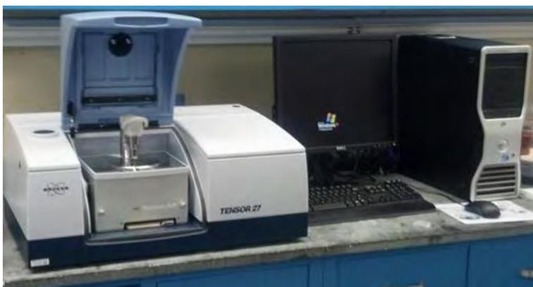
**Fig. 22. Espectrómetro Infrarrojo -TF (IIM)**
