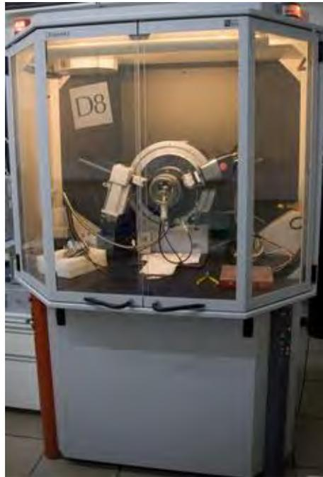
**Figura 24. Difractómetro Bruker D8 (UV- MicroNa).**
