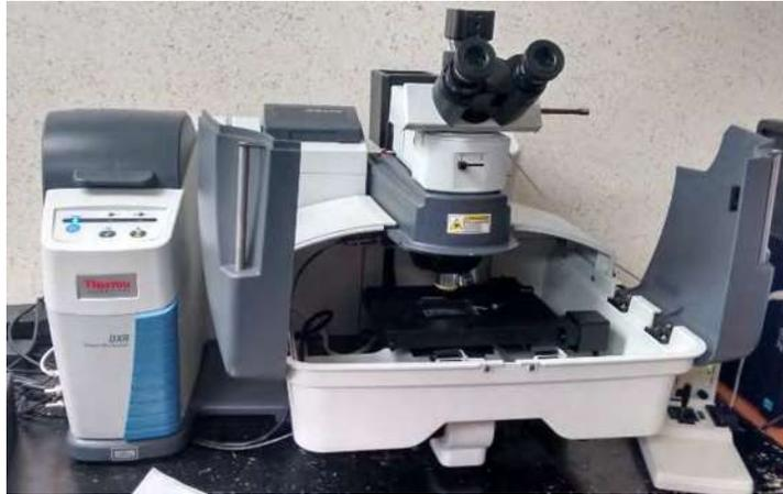
Fig. 23. Espectrómetro Raman (UV-MicroNa)
