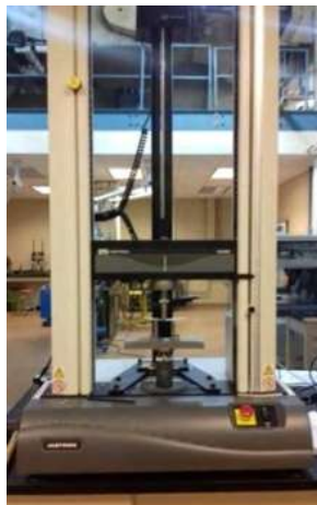
Figura 4.4 Ensayo de flexión en el laboratorio del departamento de Ingeniería Química de Queen's University.
