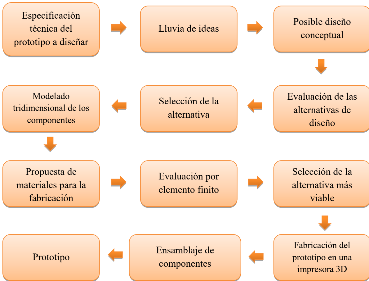
Figura 1.2 Metodología propuesta a seguir para el diseño del prototipo, de forma general.
