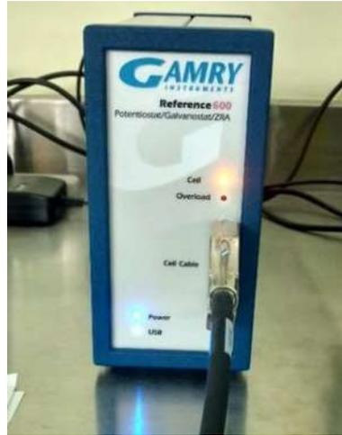
Figura 133. Potenciostato modelo Reference 600 de la marca Gamry Instruments.
