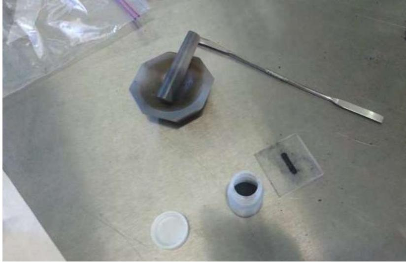
Figura 12. Instrumentos utilizados para la obtención y caracterización de grafito por el método de DRX.
