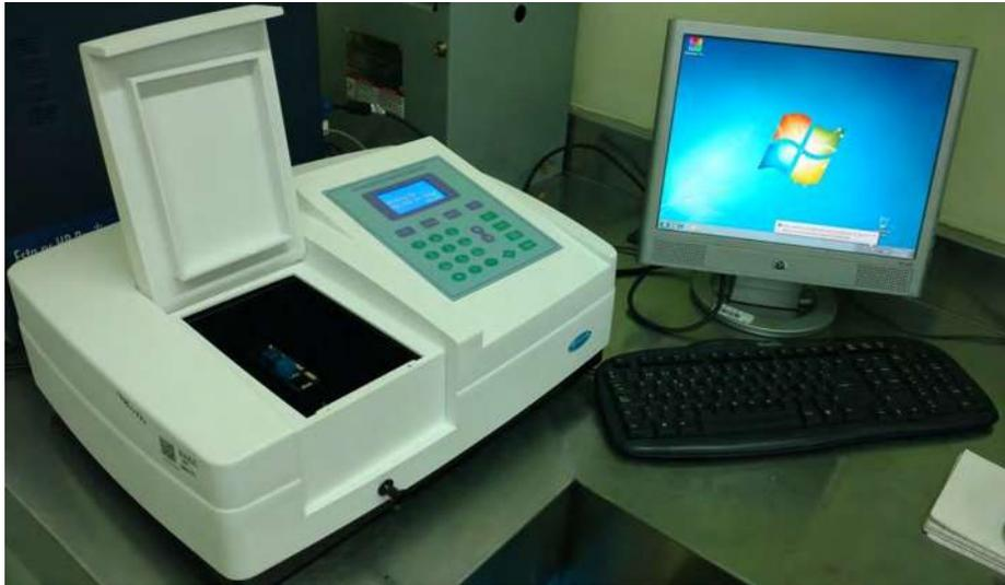
Figura 125. Equipo de Espectroscopía de luz UV utilizado para evaluar las propiedades de fotocátalisis de las muestras.
