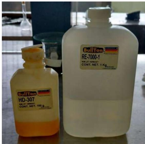
Figura 130. Sistema epóxico para laminado estructural de la compañía Bullton.
