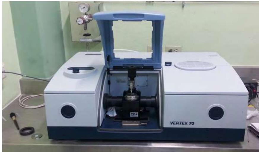
Figura 21. Equipo de Espectroscopia Infrarroja (Bruker, modelo Vertex 70).
