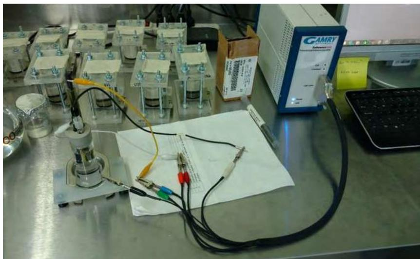
Figura 134. Celda electroquímica montada para pruebas con el potenciostato.
