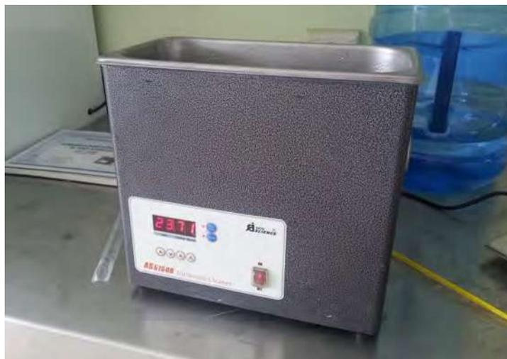
Figura 29. Equipo de Ultrasonido (Auto Science, Ultrasonic Cleaner, modelo AS5150B).
