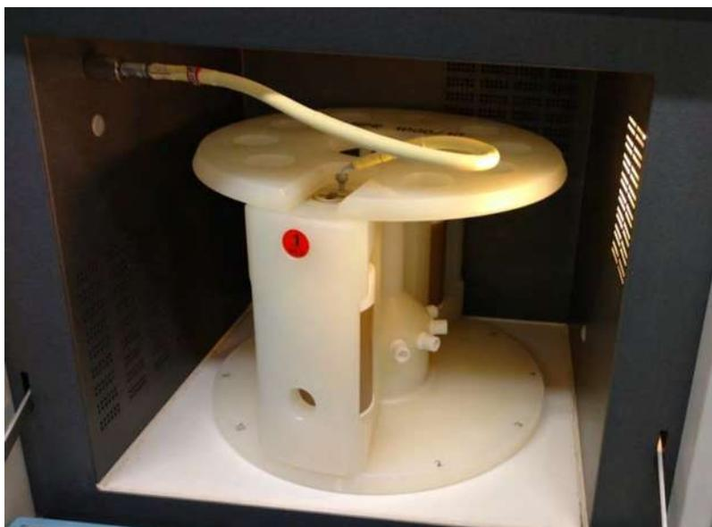
Figura 97. Recipientes colocados en el Digestor para realizar la síntesis hidrotermal.
