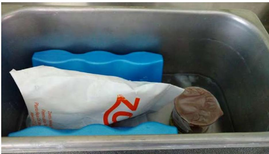
Figura 43. Configuración empleada en la sonicación de la muestra para mantener la temperatura a 5 °C.
