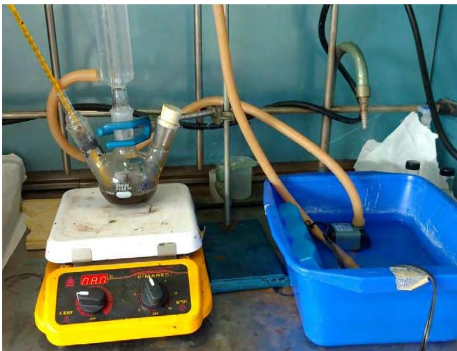
Figura 36. Configuración empleada para calentar la mezcla a 98°C.
