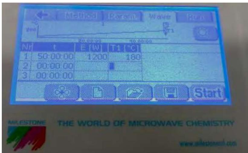
Figura 94. Pantalla táctil del digestor, en donde se establecen los parámetros de temperatura, potencia límite y tiempo.
