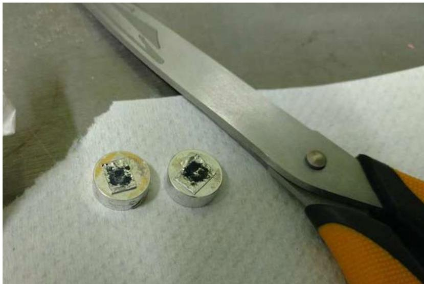
Figura 17. Muestras preparadas para caracterizar en el MEB.
