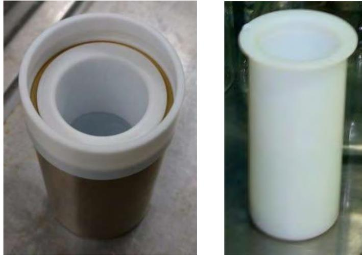
Figura 92. Partes de un recipiente del digestor: cilindro café con vaso y anillo (izquierda), vaso para colocar la solución (derecha).
