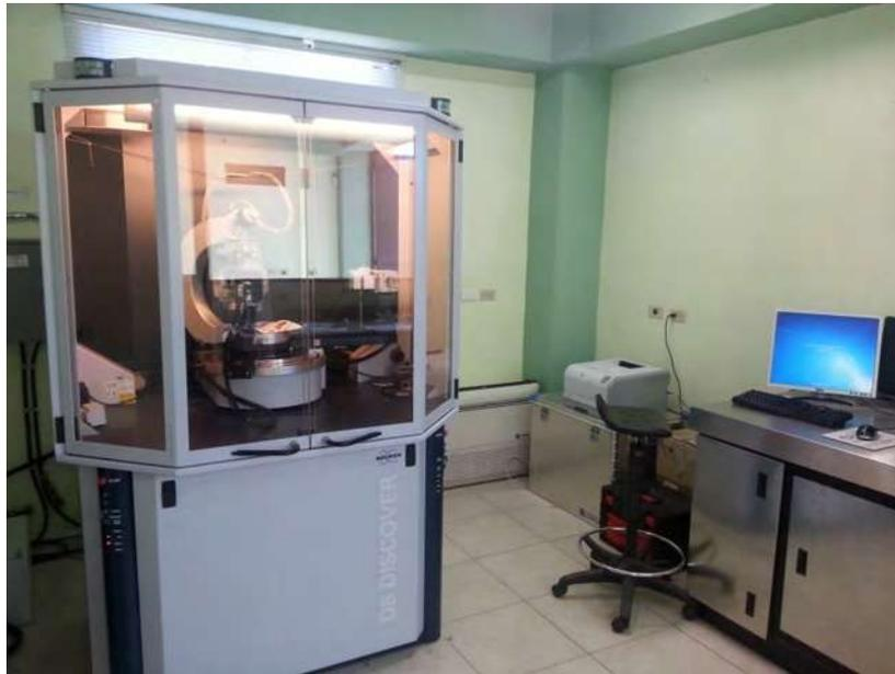
Figura 13. Equipo de Difracción de Rayos X (D8 Discover, marca Bruker)
