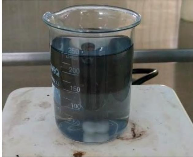
Figura 50. Proceso de reducción de óxido de grafeno empleando ácido ascórbico.
