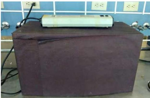
Figura 121. Configuración de lámpara de luz ultravioleta y “caja oscura” para pruebas de fotocatalisis.
