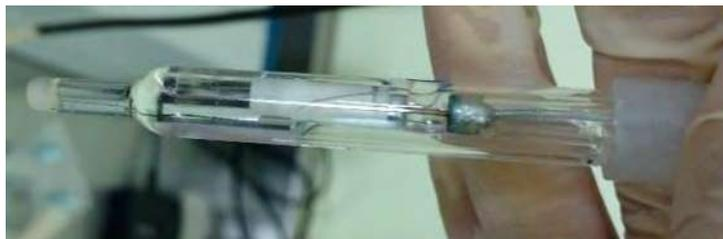
Figura 135. Electrodo de referencia de calomel.
