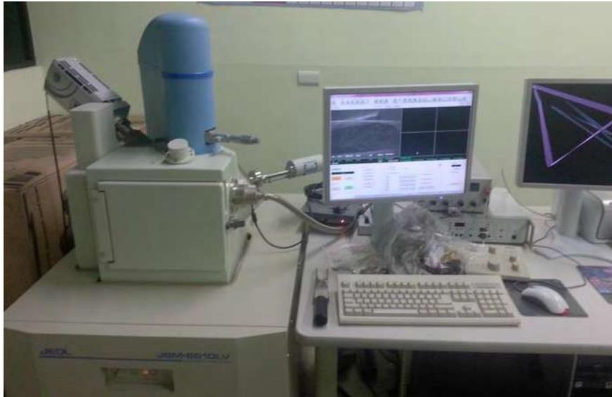
Figura 16. Microscopio Electrónico de Barrido, modelo JSM - 6610LV, de la marca JEOL
