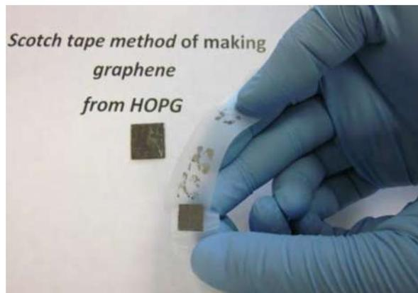
Figura 2. Exfoliación mecánica del grafeno a partir del grafito pirolítico altamente orientado usando cinta adhesiva [19].
