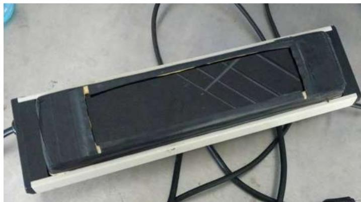
Figura 120. Lámpara de luz ultravioleta utilizada para las pruebas de fotocatalisis.
