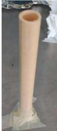
Figura 129. Molde de PVC empleado para fabricar el electrodo de trabajo.
