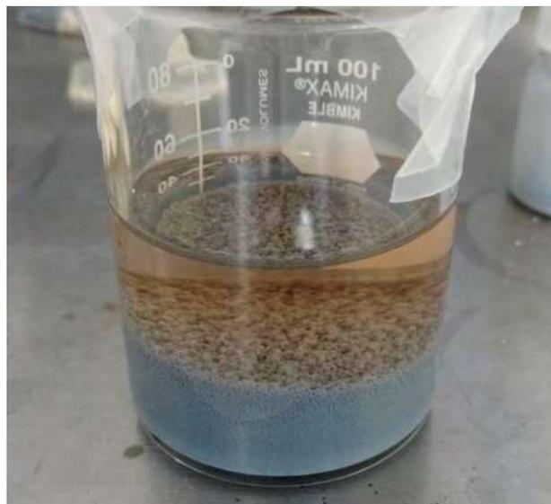
Figura 112. Compósito GO/TNT obtenido por el método hidrotérmal.
