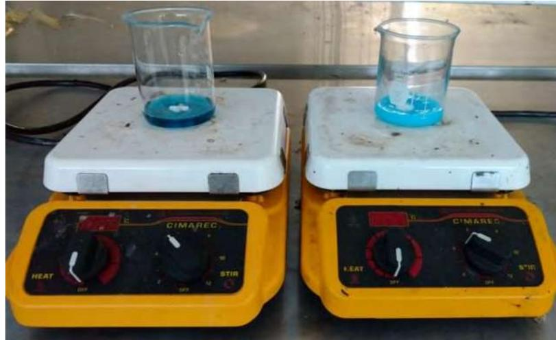
Figura 122. Muestras para pruebas de fotocatalisis colocadas sobre parrillas: óxido de grafeno (izquierda), titania comercial (derecha).
