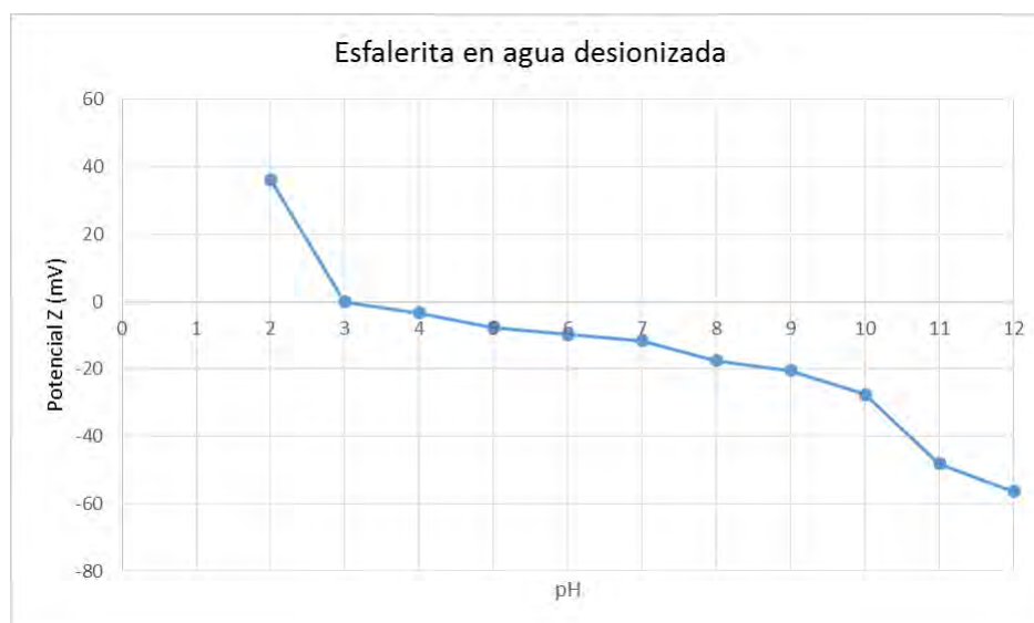
Figura 4.29 Potencial Z de Esfalerita en agua desionizada.
