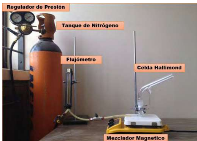
Figura 3.12 Montaje experimental para realizar microflotación.
