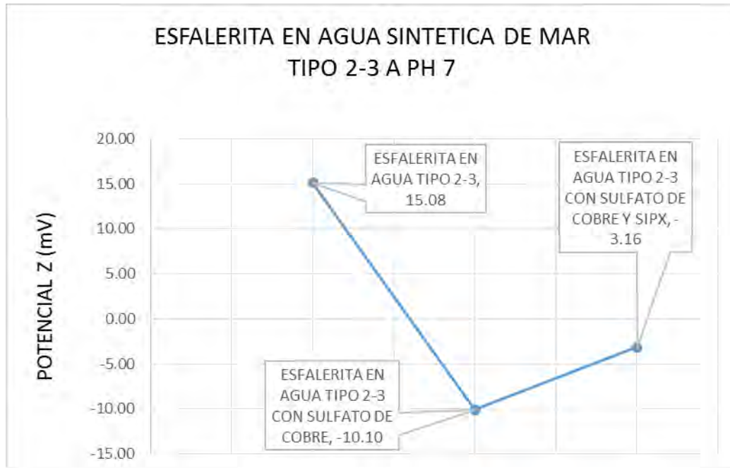
Figura 4.34 Potencial Z de Esfalerita, Esfalerita + cobre y Esfalerita + Cobre + SIPX en agua sintética de mar tipo 2-3 a pH de 7.
