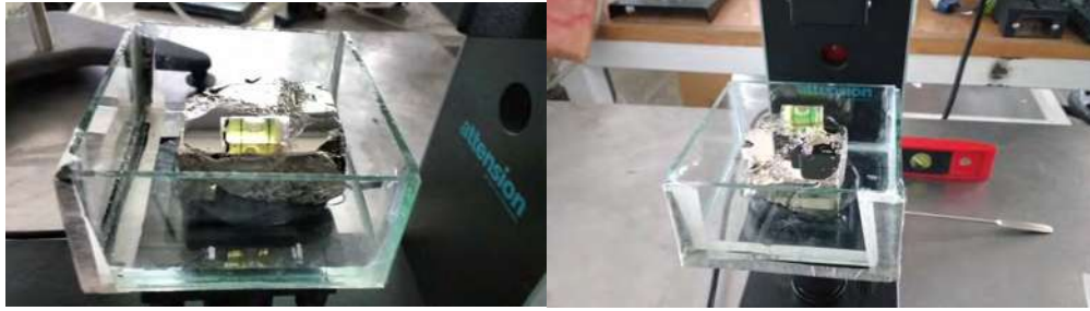
Figura 2.4 Método para nivelar la muestra de pirita sobre un plano.
