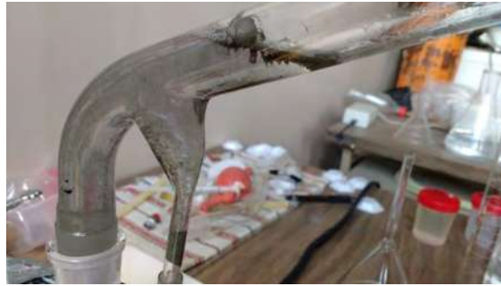
Figura 3.17 Flotación de pirita con agua de mar a un pH de 5.
