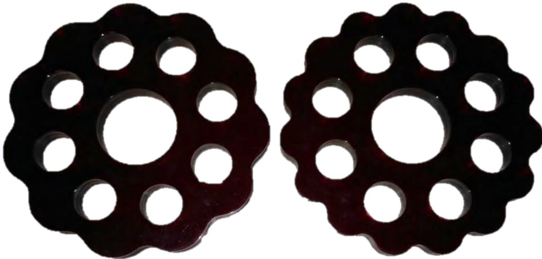
**Figura 4. 31.** Manufactura de familia de engranes cicloidales parametrizados
