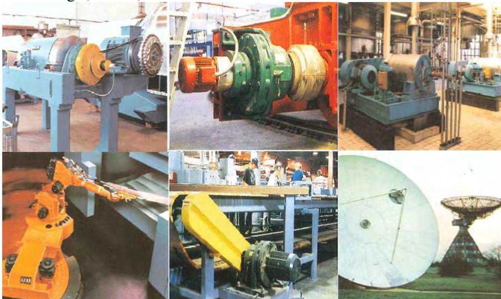
Figura 2.2. Aplicaciones más representativas del reductor cicloidal, (F.J. Rubio, 2010).
