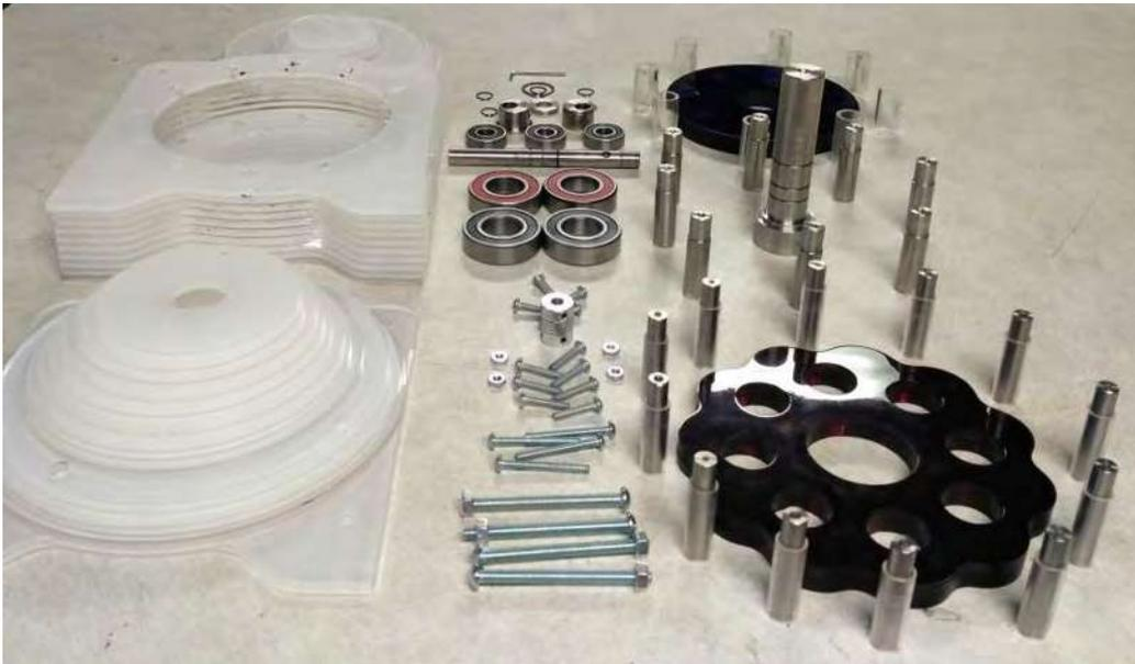
**Figura 4. 33.** Piezas manufacturadas de reductor cicloidal
