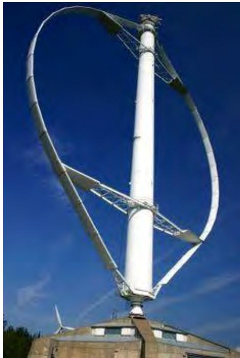
**Figura 1.11.** Aerogenerador de eje vertical.
