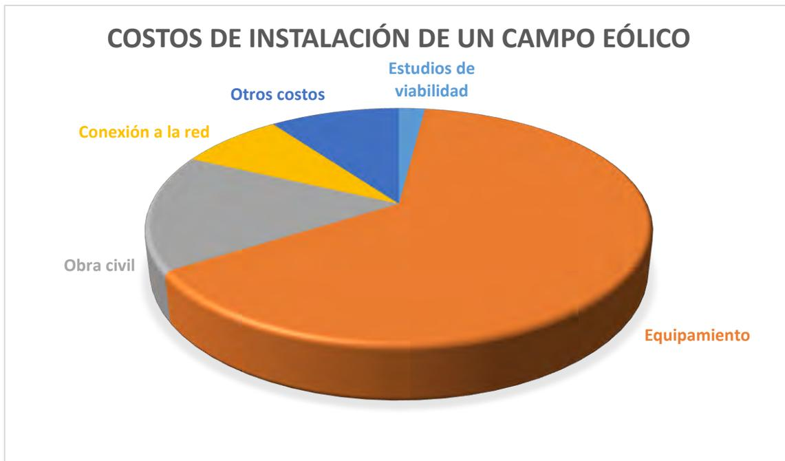
**Figura 7.1.** Proporción de costos de instalación de un campo eólico.
