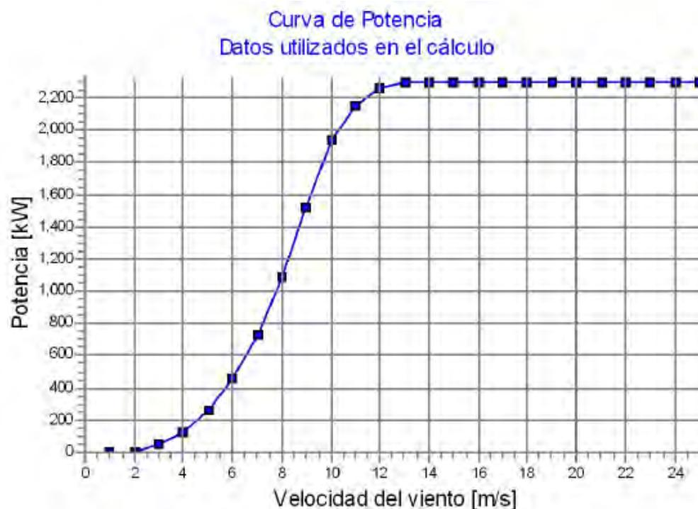
**Figura 6.39.** Curva de potencia del aerogenerador Siemens SWT-2.3-113. Cortesía Catalogo de AGs WindPRO.
