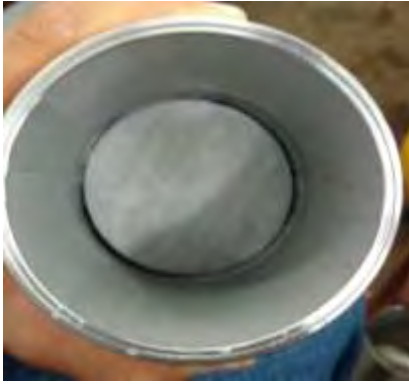
Figura 4.7. Contenedor de muestra después de la prueba de filtración con espuma.
