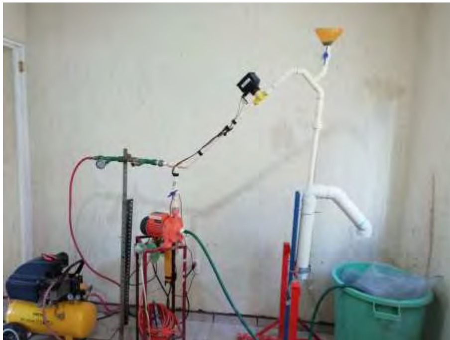
Figura 4.17. Banco experimental para pruebas de transporte de sólidos.
