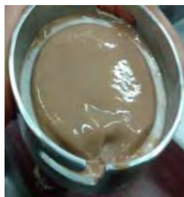
4.5 Retorta de lodo formada en el interior del contenedor de la muestra del filtro prensa.
