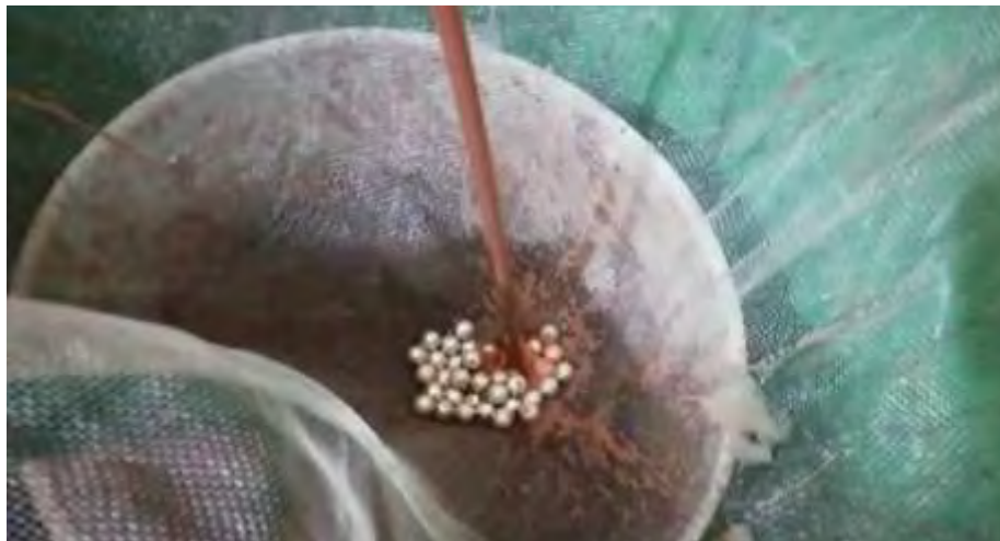
Figura 4.21. Partículas de \varnothing = 7 mm, transportadas con el lodo de perforación, a la salida de la sección de pruebas.
