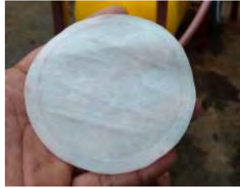
Figura 4.8. Papel filtro después de la prueba en el API Filter Press
