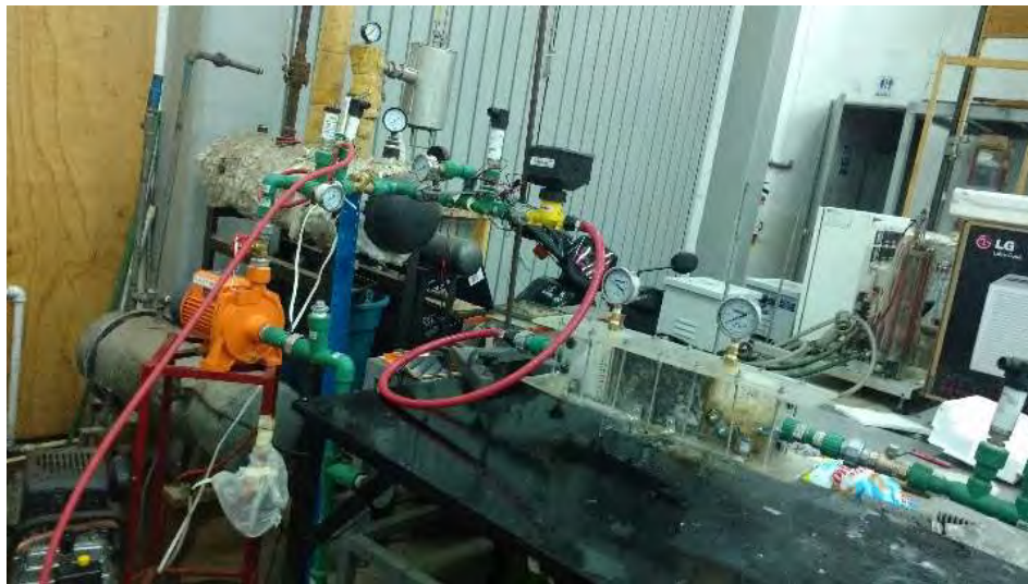
Figura 4.12. Experimento de permeabilidad basado en la Ley de Darcy.
