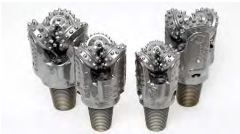
Figura 1.12. Barrenas tricónicas con incrustaciones de carburo de tungsteno (TCL).
