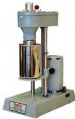
Figura 2.7. Viscosímetro de seis velocidades.
