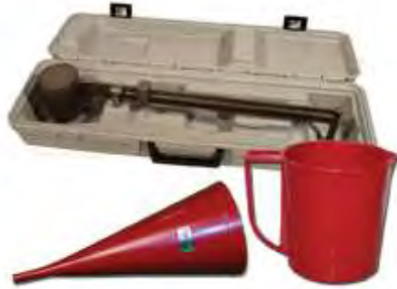
Figura 2.6. Marsh Funnel, o embudo Marsh con una balanza de lodos.
