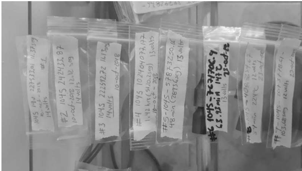
Figura 7.6. Manejo de probetas fracturadas guardadas en bolsas cerradas, para evitar la contaminación de la superficie de fractura.
