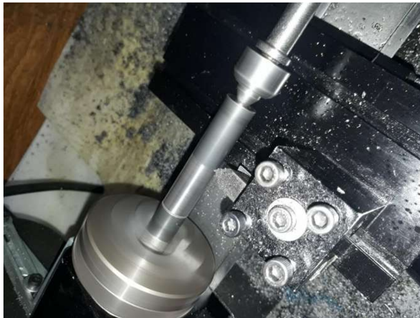
Figura 6.2 Cilindrado de probetas de acero, en torno CNC.
