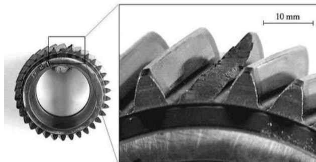
Figura 2.9 Falla por fatiga en engranes.
