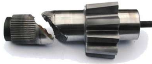
Figura 2.8. Falla por fatiga en ejes de transmisión.
