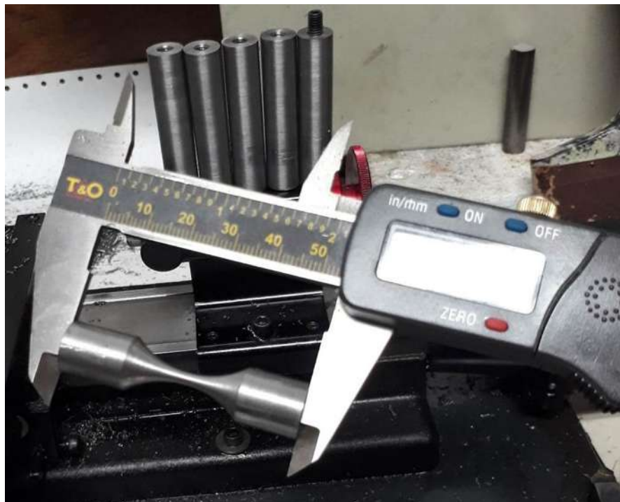
Figura 6.11. Medida de las dimensiones en vernier electrónico.
