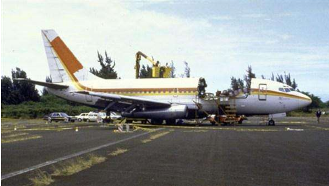
Figura 2.10. Falla por fatiga en un avión comercial (1988) [7].
