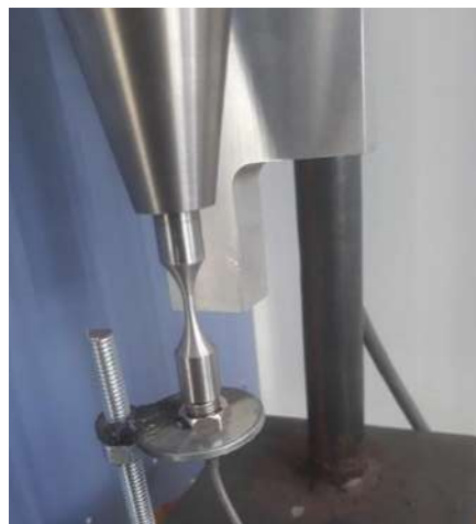
Figura 5.6 sensor inductivo de proximidad, calibrando los desplazamientos.
