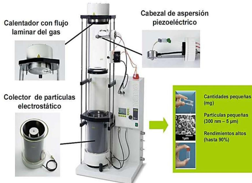
Figura 3.3: Secador Nano Nano Spray Dryer B-90 (Configuración alta) (Tomada de López, 2010).
