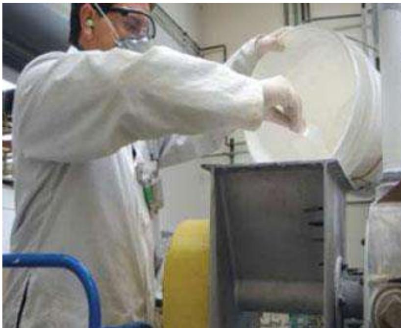
Figura 3.12: Trabajador que labora en la producción de nanopartículas viste un equipo de protección dérmico, respiratorio y auditivo y un aparato de muestreo personal de aire durante una operación de vertimiento.
