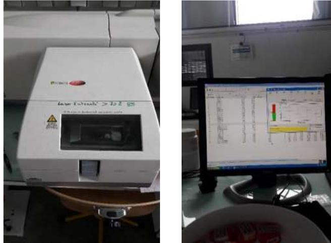
Figura 3.11: Muestra el proceso de granulómetro Malvern Mastersizer 2000 y el en ordenador se muestra la distribución de tamaños de la muestra.
