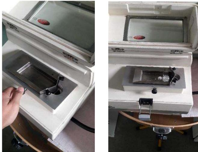
Figura 3.10: Instalación de la muestra de las micropartículas en el granulómetro Malvern Mastersizer 2000.
