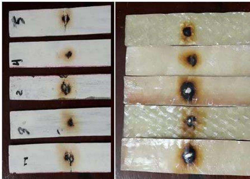
**Figura 3-14.** Efecto resultante del ensayo de fatiga a alta frecuencia en el equipo ultrasónico.
