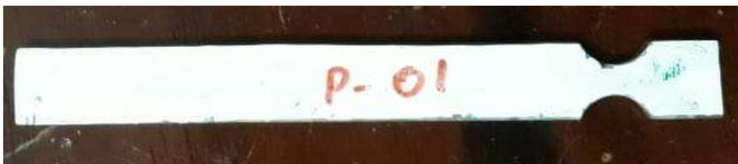
**Figura 3-10.** Geometría de la probeta utilizada en el ensayo a fatiga a baja frecuencia. Fuente Propia
