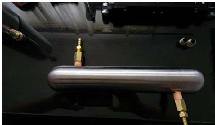
Figura 4.14 contenedor de gas hidrogeno
