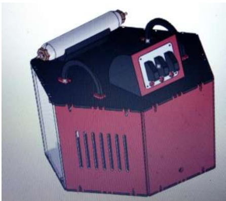
Figura 4.7 laboratorio portátil generador de hidrógeno. Figura extruida 3D
