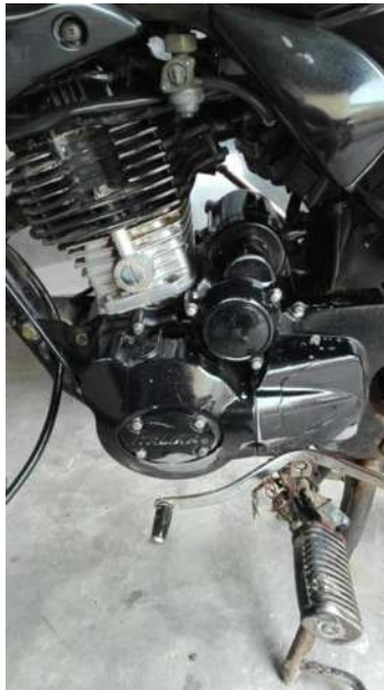
Figura 5.21 Motor de combustión interna de 150cc
