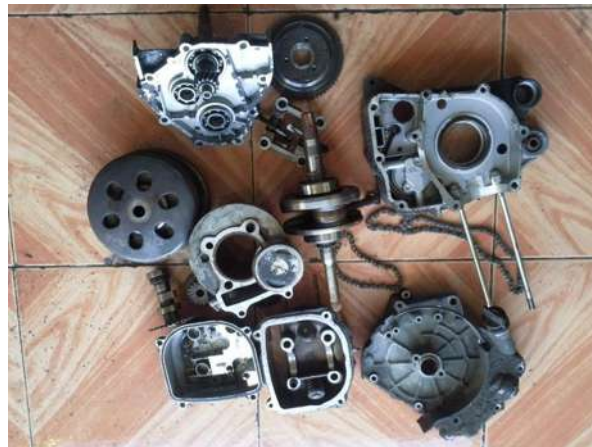
Figura 5.22 desarmada del motor de combustión interna
