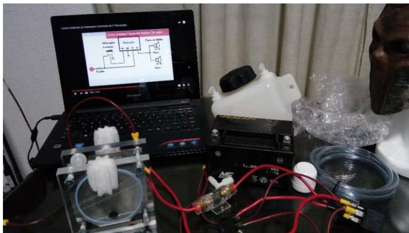
Figura 6.1 placas acero 316L optimizadoras de la electrolisis causante de la separación hidrógeno-oxígeno.
