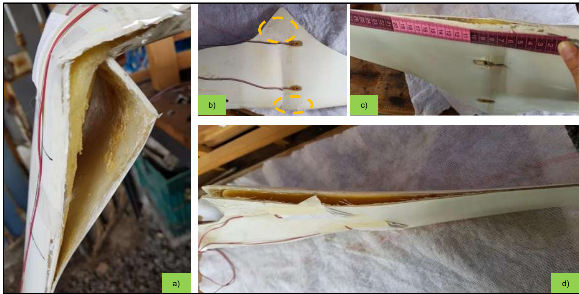
Figura 48. Falla estructural del "Álabe 1" para la hipótesis de carga H con carga F_x -eje. a) Durante la medición b) Detalle del intradós c) Detalle del extradós d) Separación del extradós e intradós
