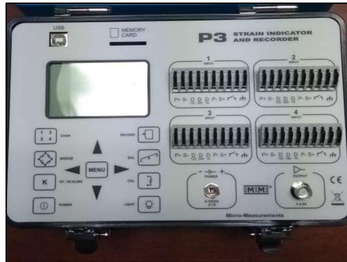
Figura 43. Indicador de tensión y registrador modelo P3.
