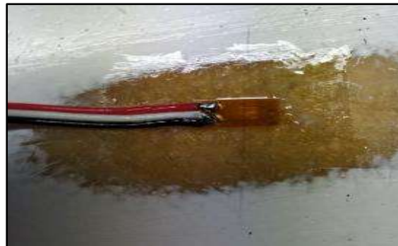
Figura 44. Pegado de una galga extensométrica en el álabo.
