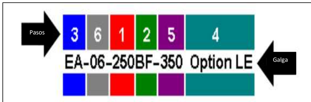
Figura 39. Pasos para la selección de galgas extensométricas [56].
