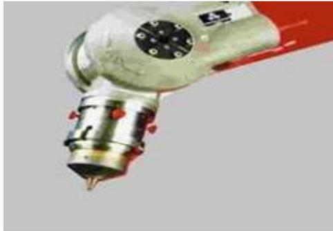
**Figura 4.2.** Efector final de función de soldador.
