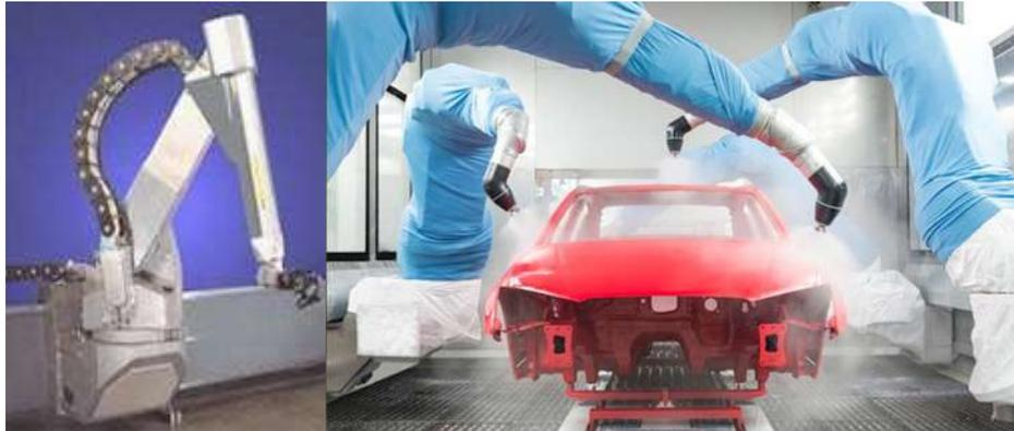
**Figura 2.10** Robot Manipulador roció de pintura.
