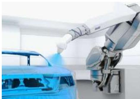
**Figura 4.3** Efector final de boquilla para pintar.
