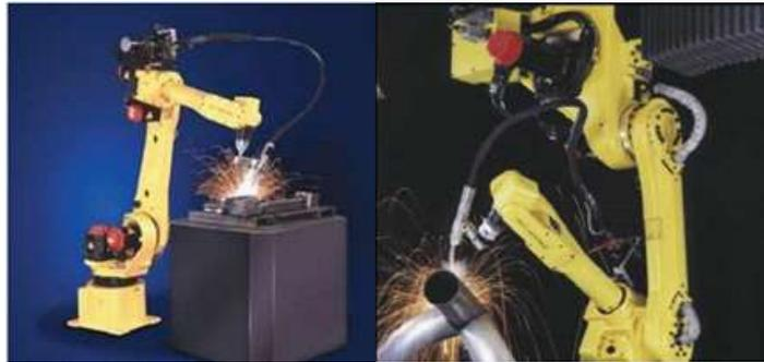
**Figura 2.7.** Robots Manipuladores diseñados para soldadura industrial.
