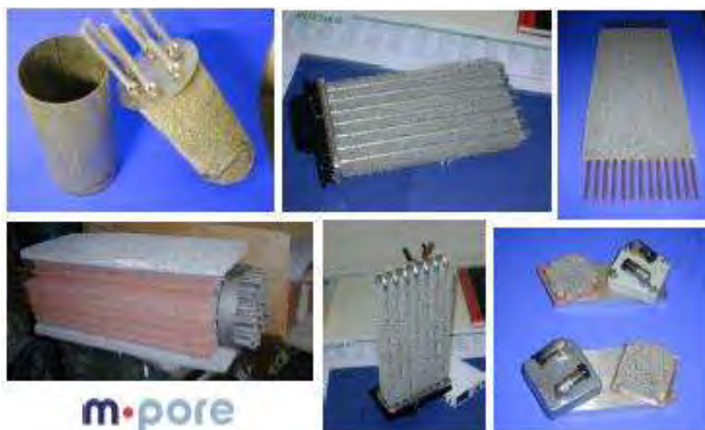
Figura 7 Diversos tipos de intercambiadores de calor basados en espumas de aluminio y cobre [6]
