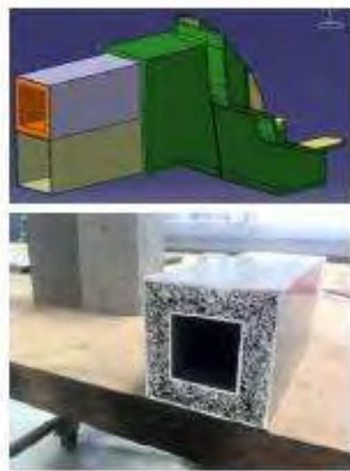
Figura 4 Prototipo de una caja para absorber impactos de un auto eléctrico. [1]
