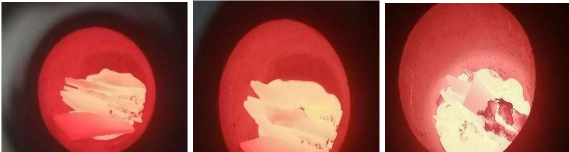
Figura 20 Proceso de fundición de las aleaciones Cu-xSn (20,24)
