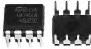
Figura 52: Encapsulado del amplificador operacional 741.
