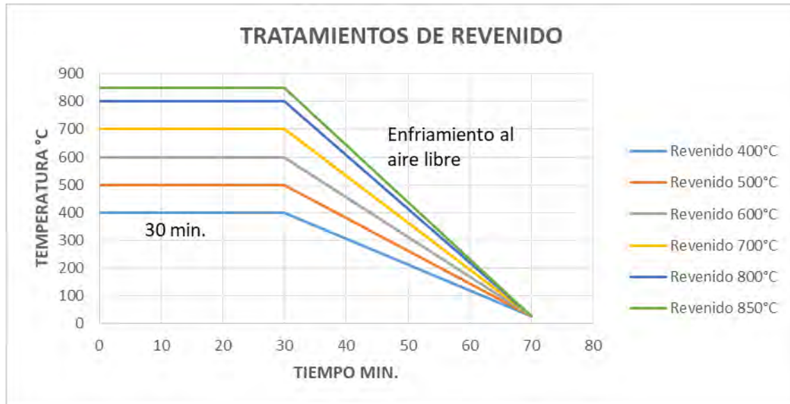
Figura 2.3 Esquema de los tratamientos térmicos de revenido.
