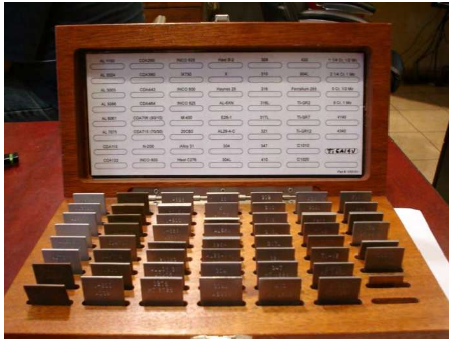
Figura 2.11 Materiales de referencia para la calibración de la conductividad eléctrica del equipo de corrientes de Eddy.
