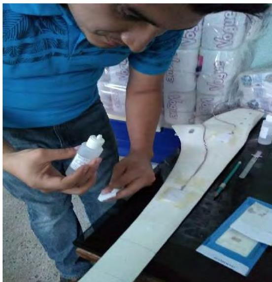
Imagen 108.- Aplicado del neutralizador 5A a la superficie.
