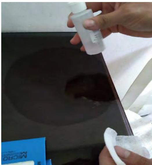
Imagen 111.- Esterilización de cristal para manipulación de galga.
