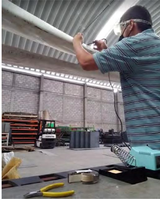
Imagen 94.- Colocación de los puntos de soldadura en la galga.
