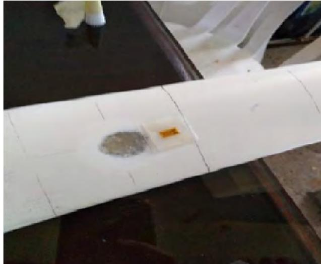
Imagen 115.- Aplicación del adhesivo sobre la galga.
