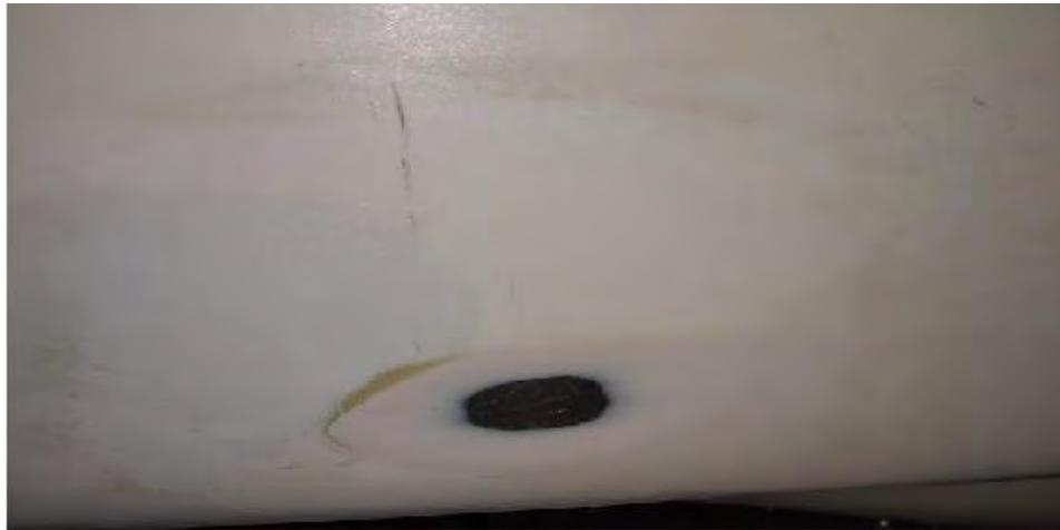
Imagen 89.- Superficie lijada lista para instalar la galga extensométrica.
