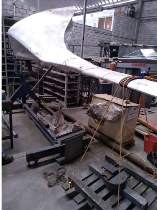
Imagen 101.- Carga colocada para la Hipótesis A: Flapwise.
