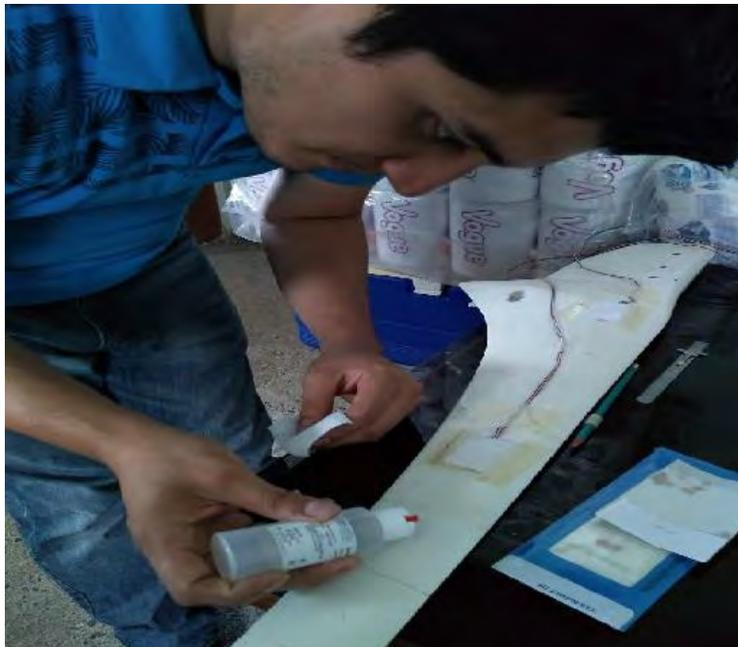
Imagen 106.- Aplicación del acondicionador 5A a la superficie.
