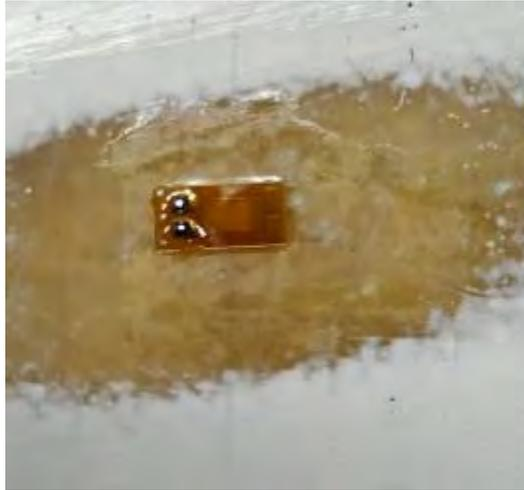
Imagen 117.- Colocación de los puntos de soldadura a la galga.
