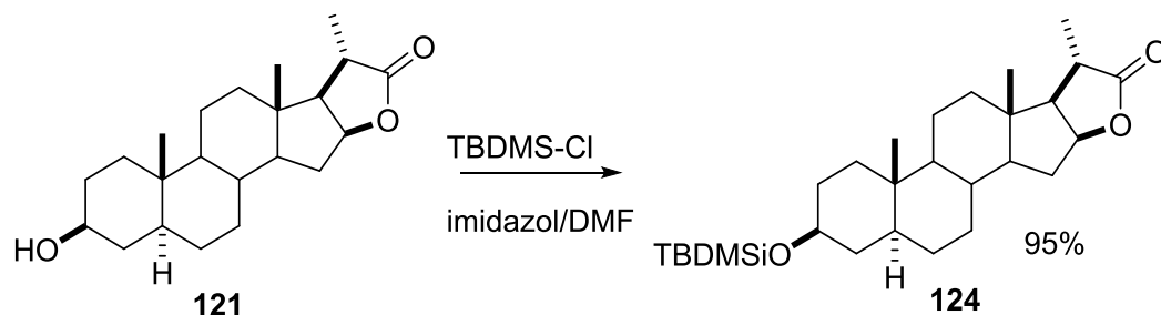
Esquema 30. Protección de la lactona 121 con TBDMS-Cl.
