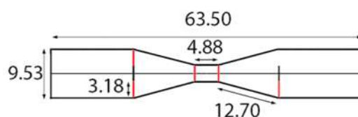
Figura 55. Esquema de las probetas empleadas para las mediciones de propiedades mecánicas, valores expresados en milímetros.
