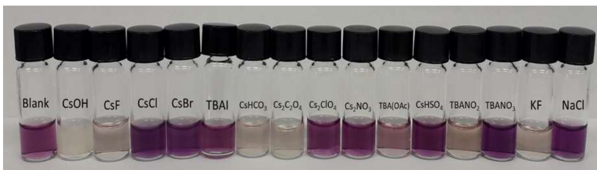
Figura 81. Ensayo preliminar del compuesto 14 frente a sales de TBAX, CsX y NaCl, serie de halogenuros (MeCN, 6 \times 10^{-4} M).
