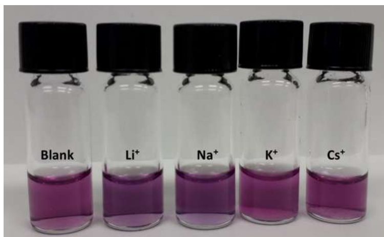
Figura 82. Ensayo preliminar del compuesto 14 frente a sales de M^{+1}ClO_4 , serie de halogenuros (MeCN, 6 \times 10^{-4} M).
