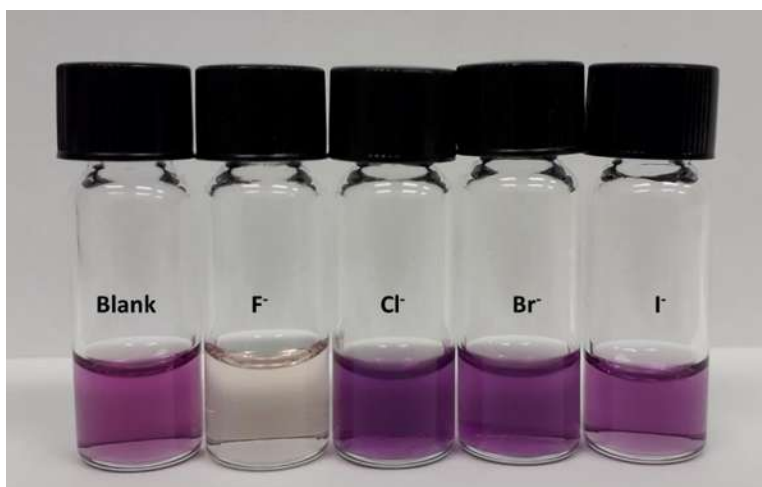
Figura 79. Ensayo preliminar del compuesto 4 frente a sales de TBAX, serie de halogenuros (MeCN, 6 \times 10^{-4} M).
