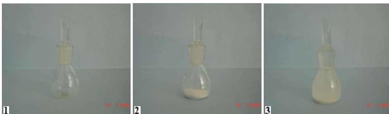
Figura B Picnómetro: (1) con agua destilada, (2) con muestra y (3) con muestra y agua destilada
