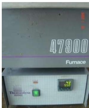
Figura 3.5 Proceso de calcinado en el \text{Al}_2(\text{SO}_4)_3 grado comercial, sin agua residual
