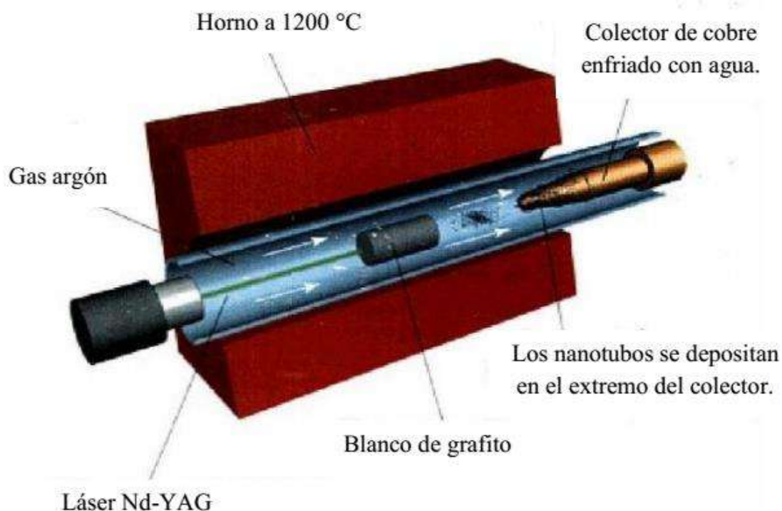
Fig. 2.15 Esquema del dispositivo para sintetizar NTC / NFC por ablación láser.
