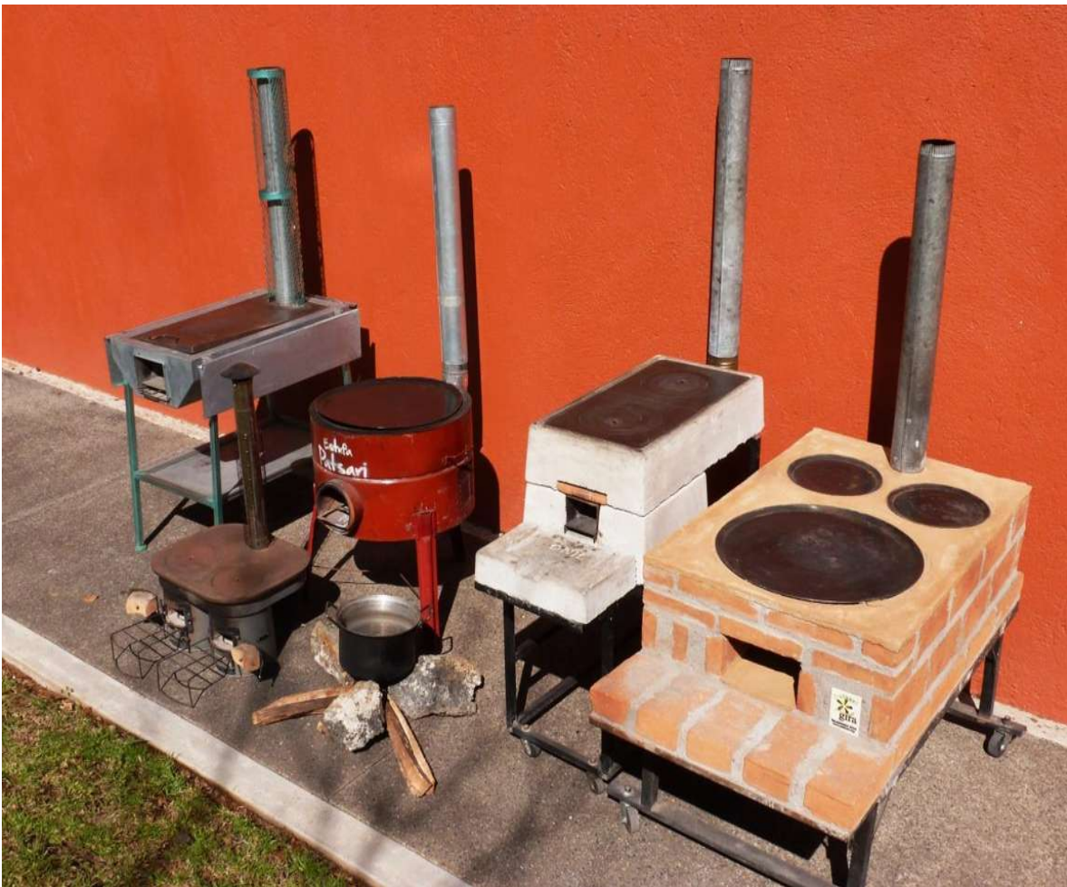
Figura 3.2 Estufas evaluadas: Ecocostufa, Mera-Mera, Patsari Portátil, TSF, ONIL y Patsari (de izquierda a derecha).
