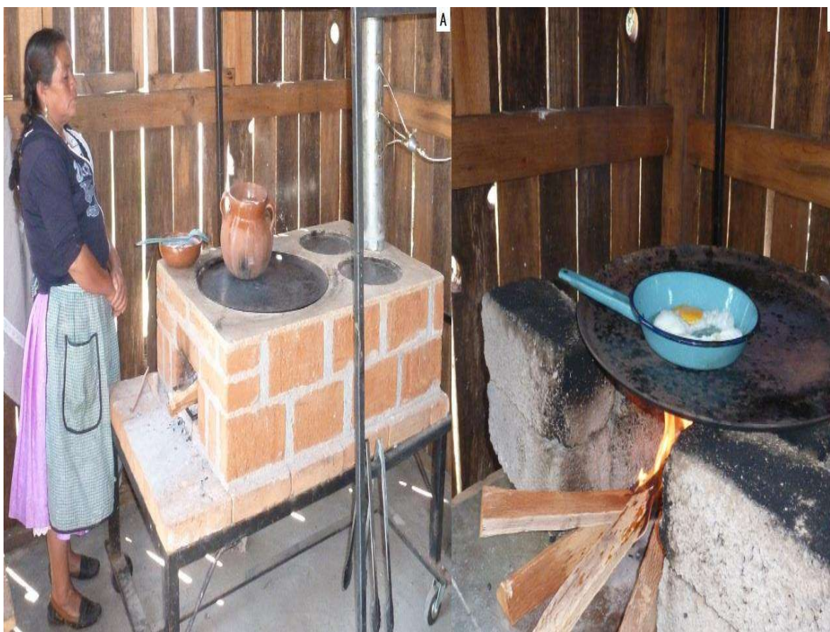
Figura 3.6 Estufas evaluadas durante las pruebas CCT: (A) estufa Patsari y (B) U-type.
