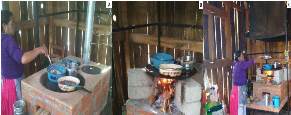
Figura C1. Secuencia de cocción simultánea realizada en el CBC para: (A) estufa Patsari, (B) TSF y (C) U-type.
