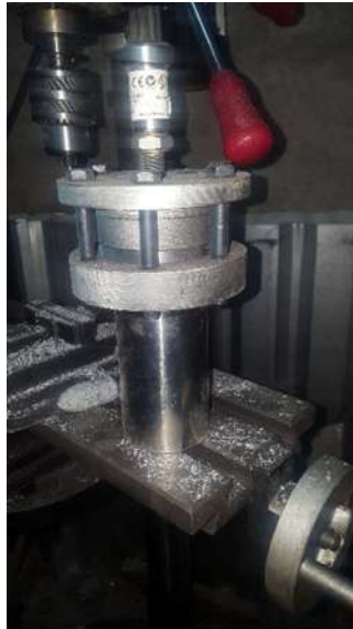
Figura IV.15. Reactor propuesto de pirolisis bridado con sensor de presión IT100.
