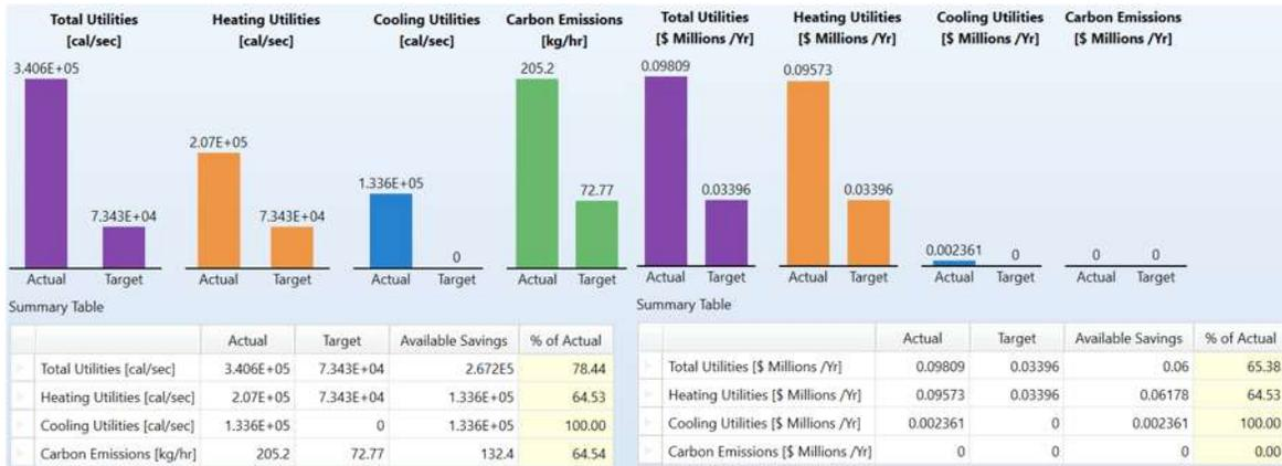
**Figura 37.** Comparación de gasto energético con y sin integración térmica para proceso de hidrólisis ácida de PET.
