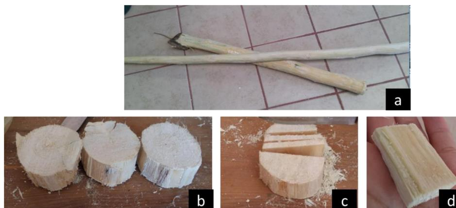
**Figura 4.2. Corte de la madera *Moringa Oleífera Lam.*: a) rama sin corteza, b y c) corte tangencial y d) astilla.**
