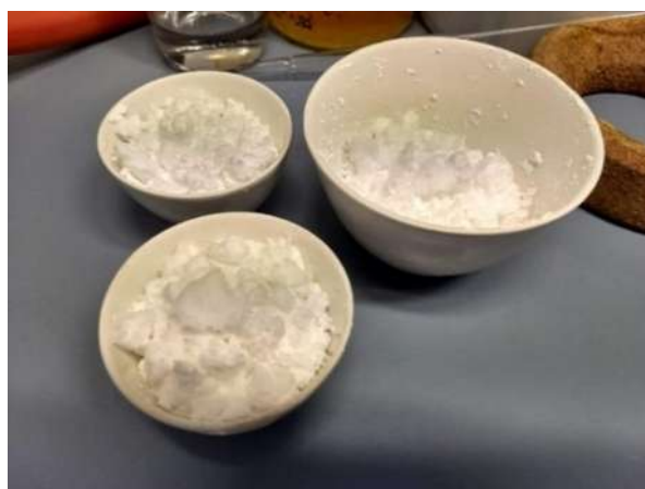
Figura 5. Preparación de sílice mesoporosa SBA-15 antes del proceso de calcinación.
