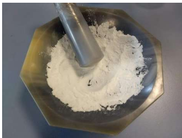
Figura 8. Trituración de materiales TiO 2 soportados en SBA-15 en un mortero de ágata.
