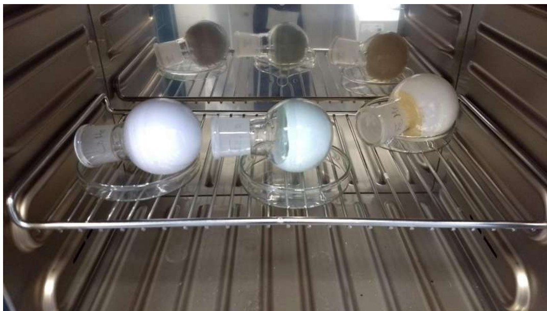
Figura 49. Fotografía de los catalizadores impregnados con sales metálicas en el paso de secado
