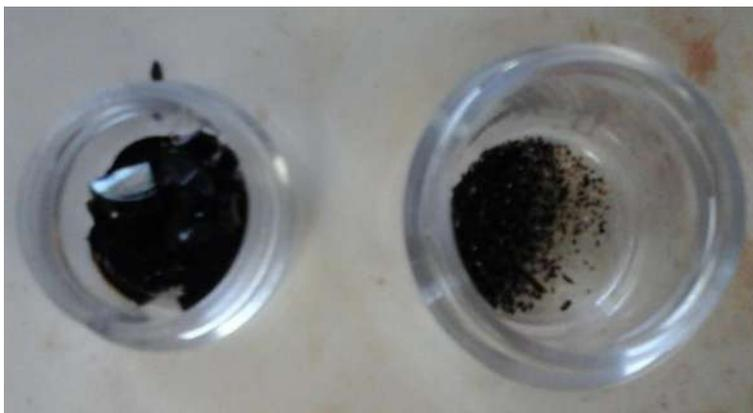
**Figura 4.3. Materiales de Si tratados térmicamente a 500°C.**
