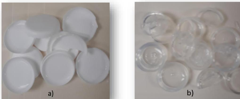
**Figura 4.12. Monolitos de  $\text{TiO}_2\text{-SiO}_2$  obtenidos de forma in-situ: a) Adición directa del precursor de Ti, b) Adición del precursor de Ti como un sol.**
