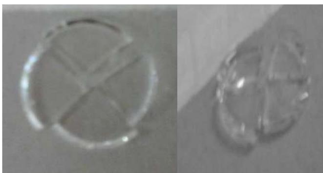
**Figura 4.2. Materiales fracturados durante el proceso de secado.**
