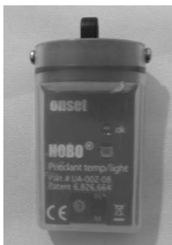
Figura 3. Hobo utilizado para colecta de temperaturas.
