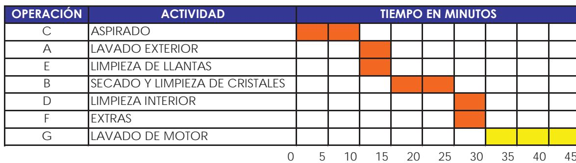
Como se observa, el tiempo estimado para el lavado EXPRESS será de 15 min, para el BÁSICO será de 30 y para el TOTAL de 45.
