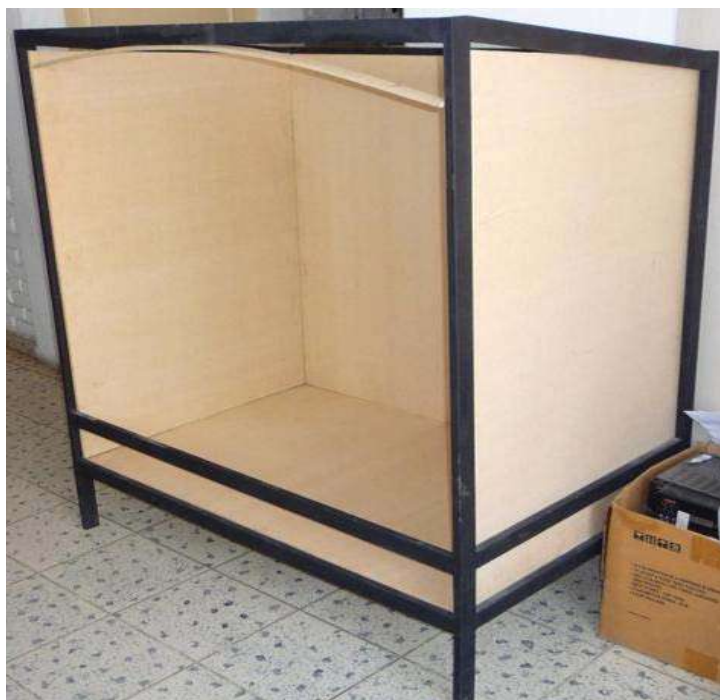
Figura 5.11: Cortes del MDF para las paredes del deshidratador.
