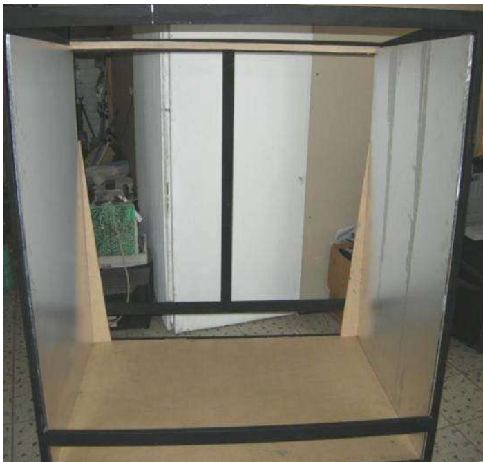
Figura 5.12: Caras laterales con placa metálica adheridas con adhesivo al MDF.
