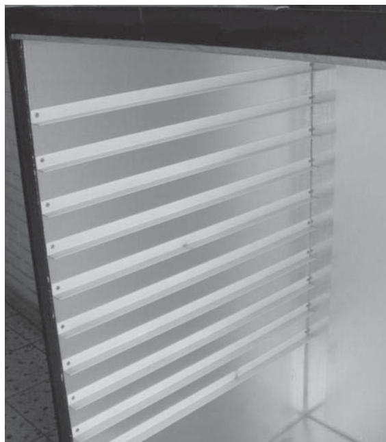
Figura 5.13: Guías de bastidores en cara lateral del deshidratador.
