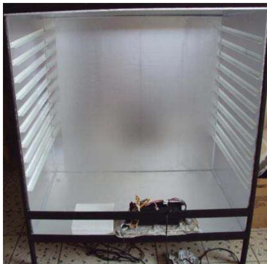
Figura 5.17: Unidad calefactora montada en el deshidratador.
