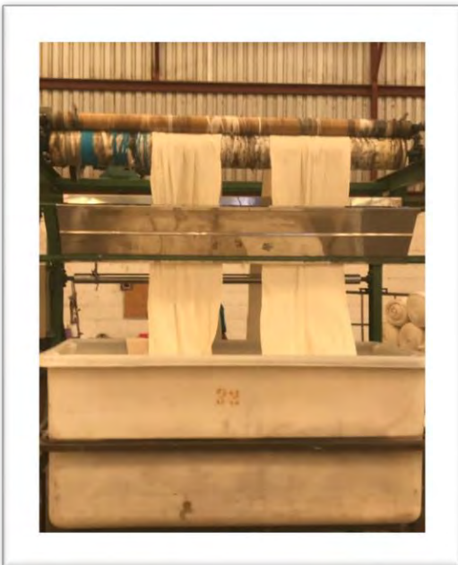
Ilustración 11 Área de devanado a y b. (máquinas en las que se une la tela y se prepara para introducirlas en las lavadoras para teñirla).
