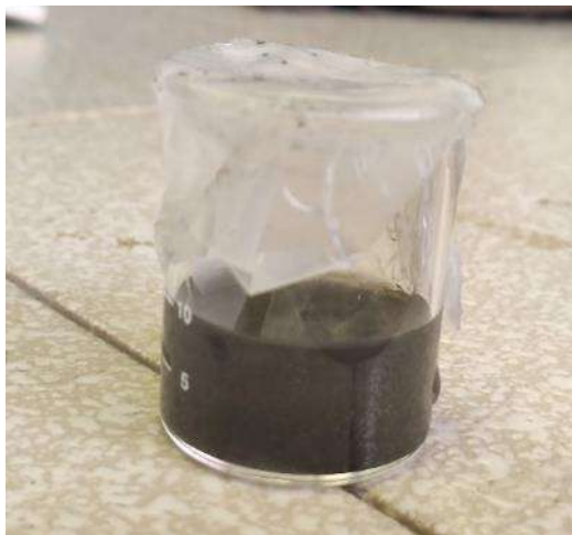
Figura 3.10 Grafeno exfoliado y sonicado suspendido en alcohol etílico.
