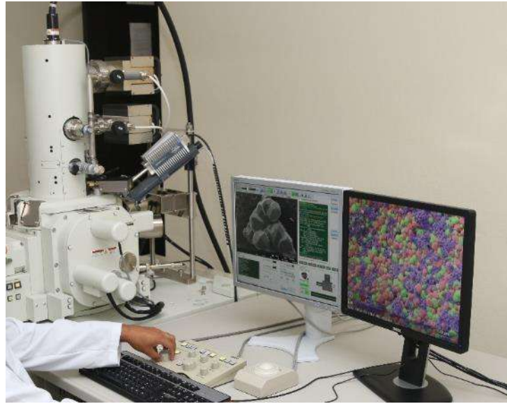
Figura 3.27 Microscopio Electrónico de Barrido (MEB) de la marca JEOL, modelo JSM 7600F.
