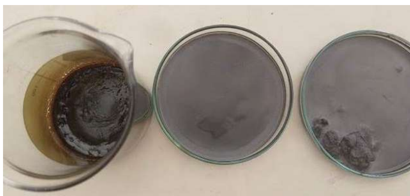
Figura 3.14 Vaso de precipitados con grafeno (izquierda), cajas de Petri con mezcla de grafeno y grafito (en medio) y el sólido más denso de grafito menos exfoliado (derecha).
