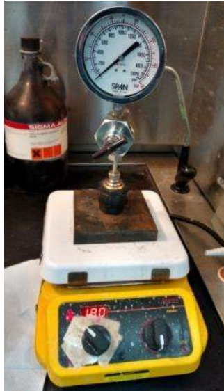
Figura 3.18 Autoclave y parrilla utilizadas en el tratamiento hidrotermal de la anatasa.
