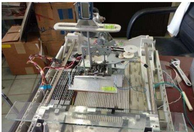
Figura 3.22 Equipo de recubrimiento por flujo utilizado para obtener películas delgadas.
