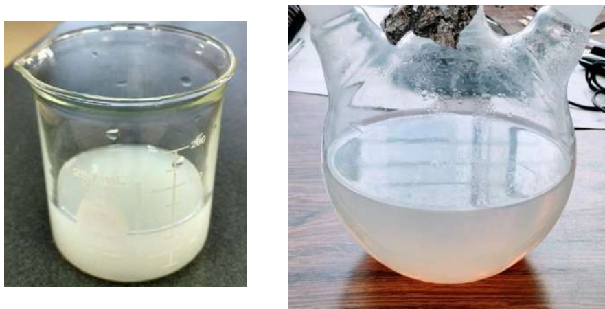
Figura 3.17 Diferencia en la coloración de \text{TiO}_2 obtenido previamente (izquierda) y el obtenido con el método sol-gel modificado (derecha).
