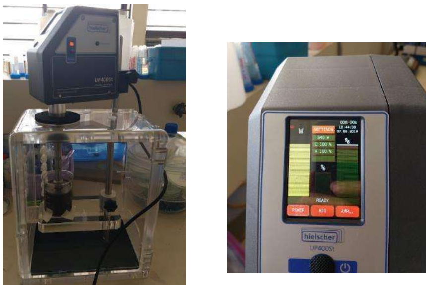
Figura 3.12 Arreglo experimental utilizado en la sonicación de la solución de té negro y grafito con el procesador ultrasónico de la marca hielscher, modelo UP400St (izquierda) e interfaz del equipo en donde se seleccionó una potencia de 340 W en la sonicación (derecha).
