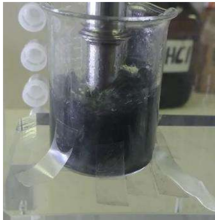
Figura 3.15 Hojuelas de grafito dispersadas en acetona y agua con lanza ultrasónica.
