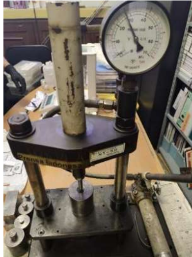
Figura 3.4 Prensa hidráulica y dado utilizados para fabricar el electrodo de trabajo de grafito a partir de hojuelas de grafito.
