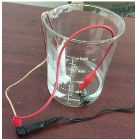
Figura 3.5 Configuración empleada para la exfoliación electroquímica de grafito con electrodo de trabajo de barra de grafito comprimido y contraelectrodo de cobre.
