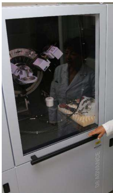
Figura 3.23 Equipo de Difracción de Rayos X modelo D8 Advance Davinci.
