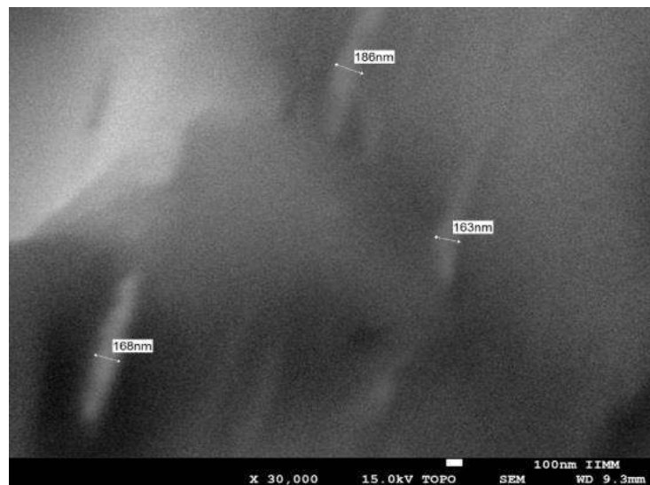
Figura 4.15 Imagen del MEB de la muestra de grafeno exfoliado en modo topográfico (30,000X) con cotas de medición para determinar la longitud de las dimensiones de las capas de grafito.
