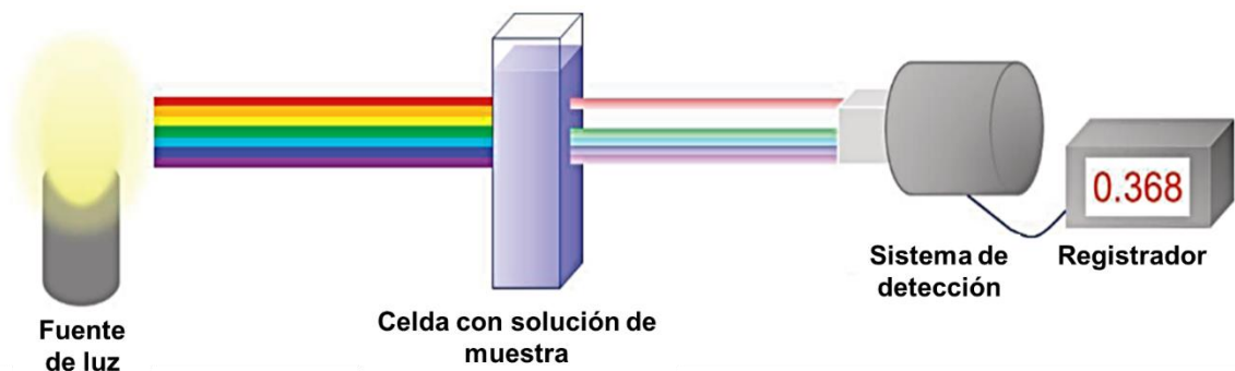
Figura 2.39 Principio de funcionamiento del equipo de espectroscopía UV-vis [115].
