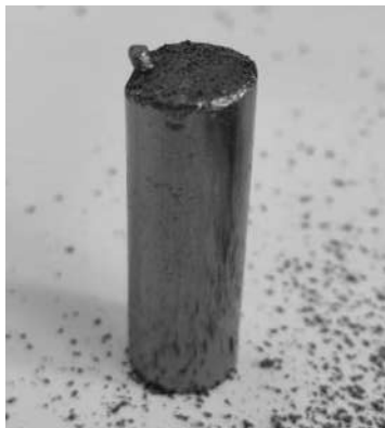
Figura 3.7 Electrodo de grafito comprimido con alambre de cobre en el interior.
