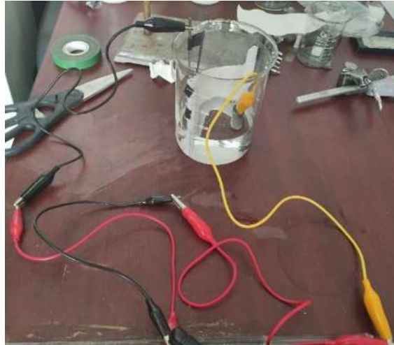
Figura 3.8 Configuración empleada para la exfoliación electroquímica de grafito con electrodo de trabajo de barra de grafito comprimido y contraelectrodo de acero inoxidable.
