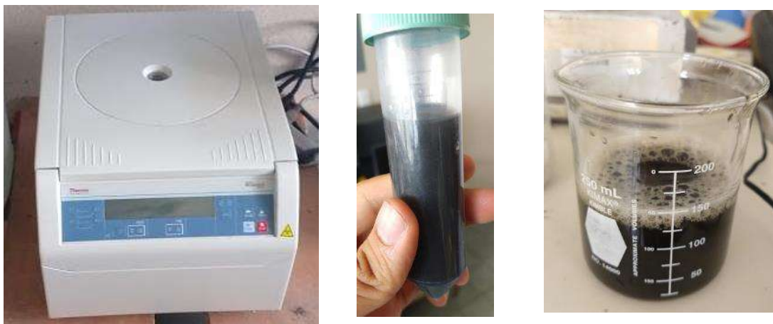
Figura 3.13 Equipo utilizado para la centrifugación de las muestras (izquierda), tubo de ensayo de plástico de 50 ml después de la sonicación (en medio) y líquido sobrenadante extraído de los tubos de ensayo (derecha).
