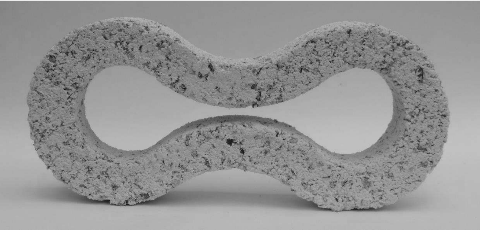
Imagen 7. Prototipo 2, Muestra 2. 3era. Iteración. Materiales: Marmolina / Vidrio triturado. Fuente: Fotografía, Carmen Ramos, 2020.
