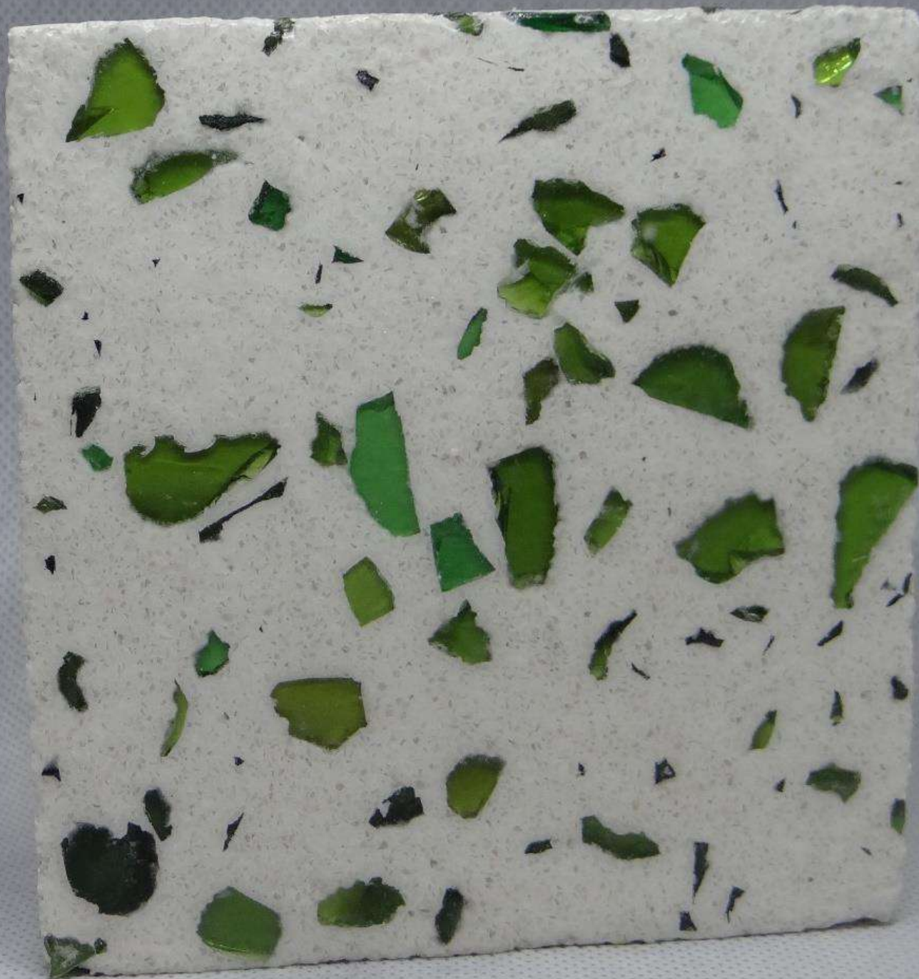
Imagen 15. Muestra 1_Cemento blanco / Marmolina / Vidrio verde triturado.
