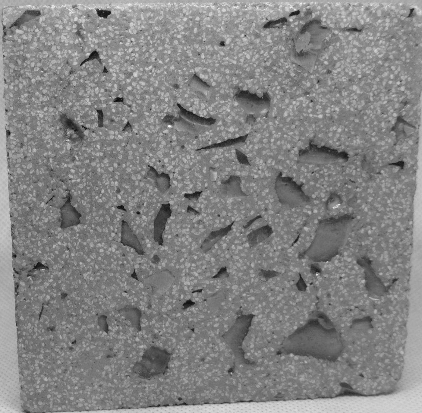
Imagen 16. Muestra 2_Cemento gris / Marmolina / Vidrio claro triturado.
