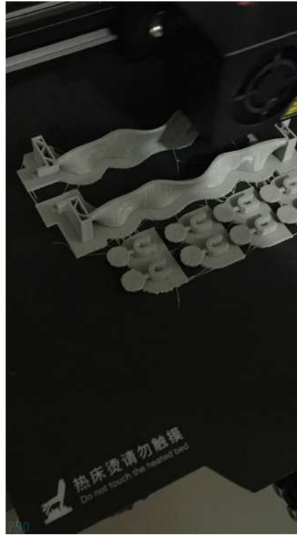
Impresión 3d de base de prototipo de molde Fig. 268. Elevación de estructura de molde impresión 3d con filamento PLA . Finalización de impresión 3d de molde para fabricación de superficie X1
