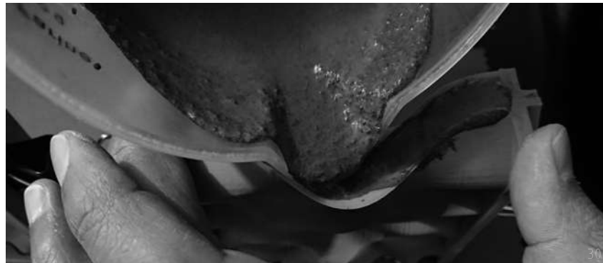
300-305) Fabricacion de pieza de concreto prototipo SPF 3.1 material portante MAB-03. Molde, impresión 3D por medio de filamento con base en el compuesto ácido poliláctico (PLA).
