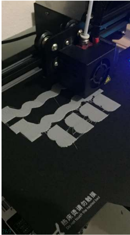
Impresión 3d de base de prototipo de molde Fig. 268. Elevación de estructura de molde impresión 3d con filamento PLA . Finalización de impresión 3d de molde para fabricación de superficie X1
