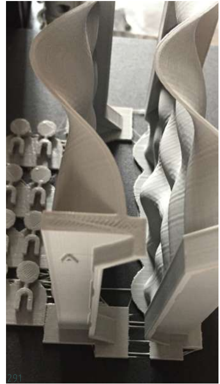
Impresión 3d de base de prototipo de molde Fig. 268. Elevación de estructura de molde impresión 3d con filamento PLA . Finalización de impresión 3d de molde para fabricación de superficie X1
