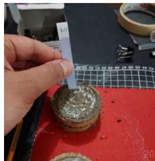
198-199) Tiras reactivas para la medición de pH en muestras de concreto. 200-201) Colocación de las respectivas tiras reactivas para la selección de muestra de concreto con tepetate y borra de café.
